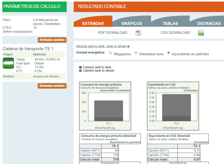
Figura B7: Emisiones con vehículo tráiler en el trayecto de Marotrell a Azuqueca de Henares con carga= 5,9 t día 12 de marzo.
