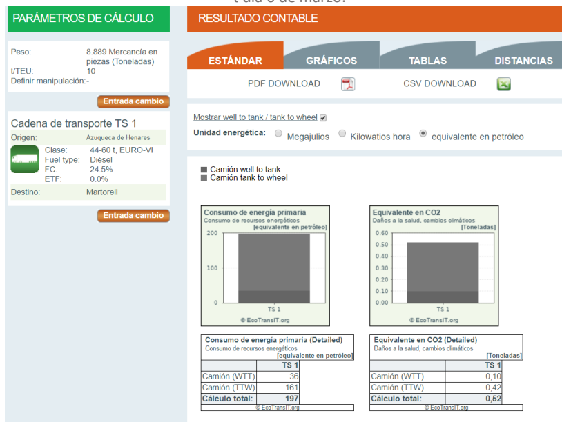
Figura B6: Emisiones con vehículo giga-tráiler en el trayecto de Azuqueca de Henares a Martorell con carga= 8,889 t día 15 de marzo.
