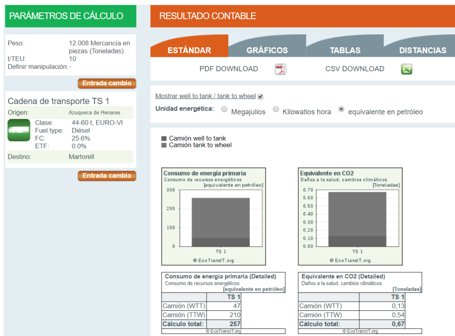
Figura B10: Emisiones con vehículo dúo-tráiler en el trayecto de Azuqueca de Henares a Martorell con carga= 12,008 t día 17 de octubre.
