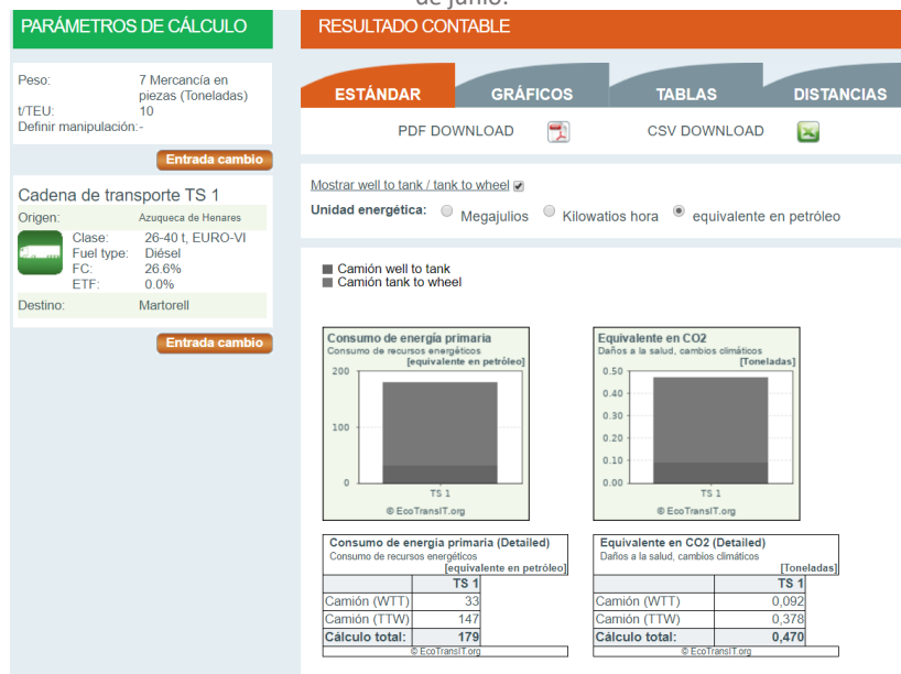
Figura B2: Emisiones con vehículo tráiler en el trayecto de Azuqueca de Henares a Martorell con carga= 7 t día 12 de junio.
