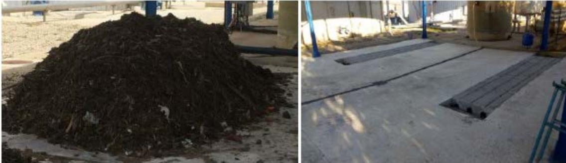
**Figura A1. Pila estática aireada; b) Sistema de aireación mediante canales**
