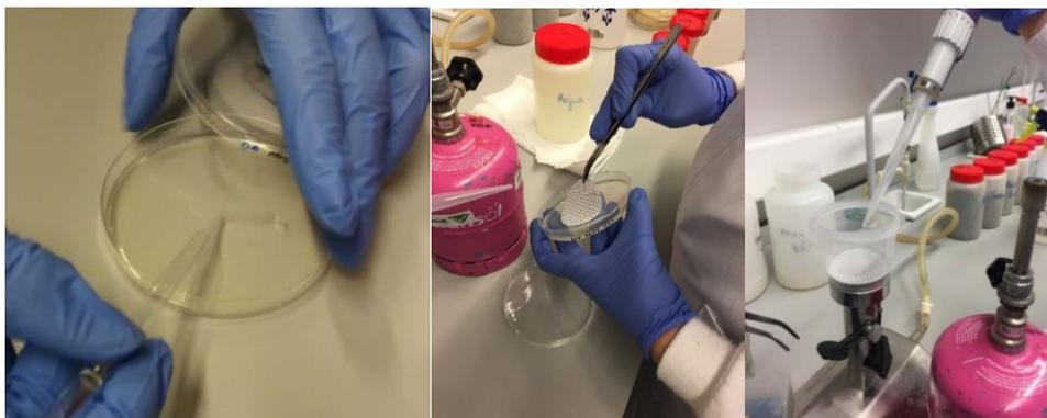
**Figura 10. Descripción del método a) Empleo del asa para esparcir el volumen; b) Colocación del filtro en la placa; c) Filtración**
