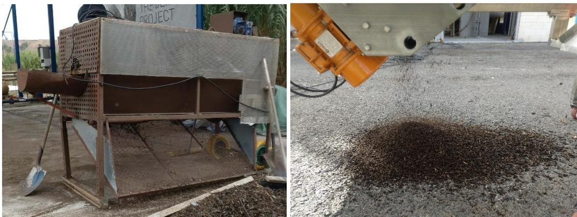
**Figura 3. Maquinaria empleada para el cribado: a) Cribadora; b) Compost cribado**
