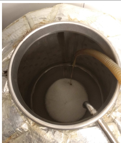
Figura 6.13. Relleno del tanque de fermentación con el mosto ya enfriado.
