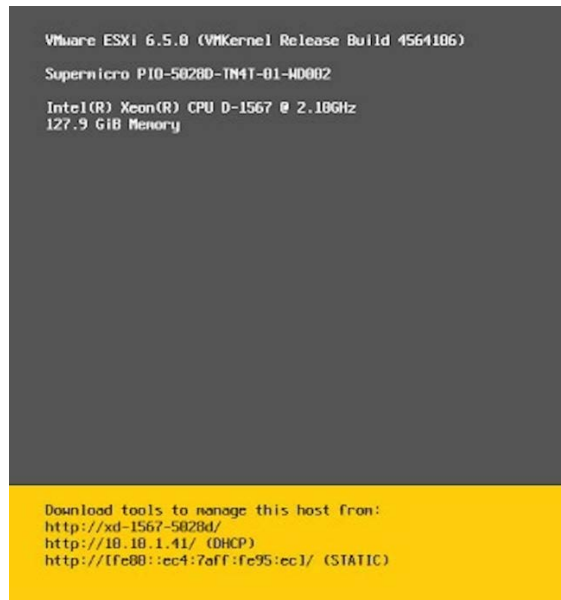
Figura 8. Vista servidor ESXi 6.5 de un nodo de SIMACET configurado.
