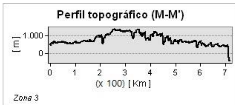
Anexo 14. Perfil topográfico de la Zona 3, donde el cambio abrupto del relieve representaría la ubicación relativa de las Fallas NS.
