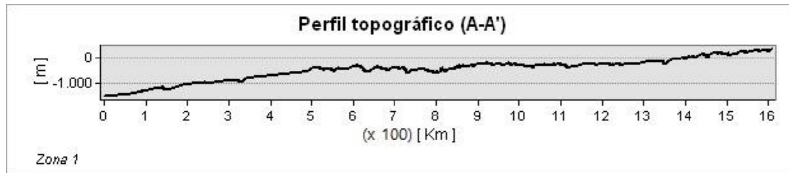
Anexo 4. Perfil topográfico A-A' de la Zona 1, donde los cambios abruptos de relieve representarían la ubicación de las Fallas NE.
