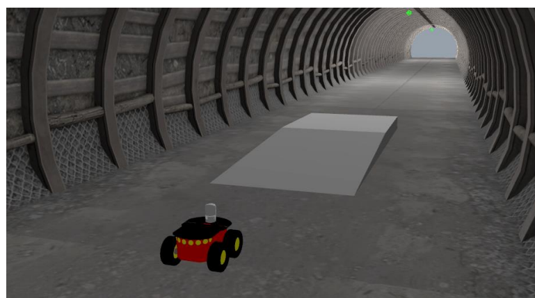
Figura 10. Escena en el simulador Gazebo donde se encuentra la rampa de 5° de inclinación
