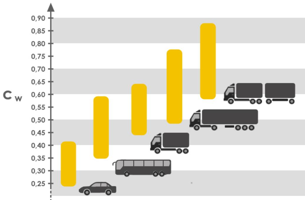
Gráfica 2. Coeficientes aerodinámicos en función del vehículo. Fuente: Aerodinámica en camiones. (15/9/2019). En Motorenmarcha. Recuperado el 17/10/2019 en <http://motorenmarcha.com/aerodinamica-en-camiones/>
