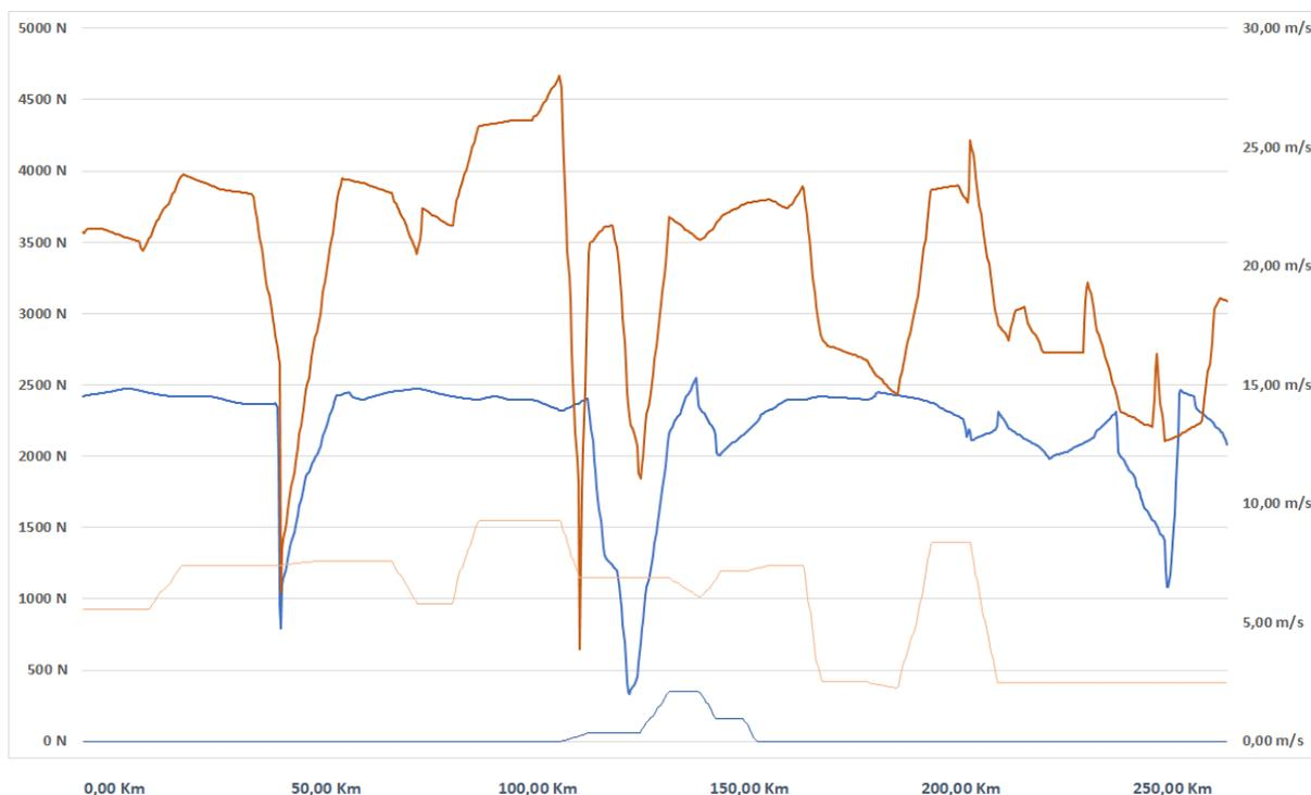
Gráfica 18. Velocidad del viento y resistencia aerodinámica en la ruta Zaragoza - Martorell (viaje 1 y 3). Curva azul oscura: resistencia aerodinámica viaje 1. Curva azul clara: velocidad del viento en el viaje 1. Curva marrón oscura: resistencia aerodinámica del viaje 3. Curva marrón clara: velocidad del viento en el viaje 3. Fuente: propia.
