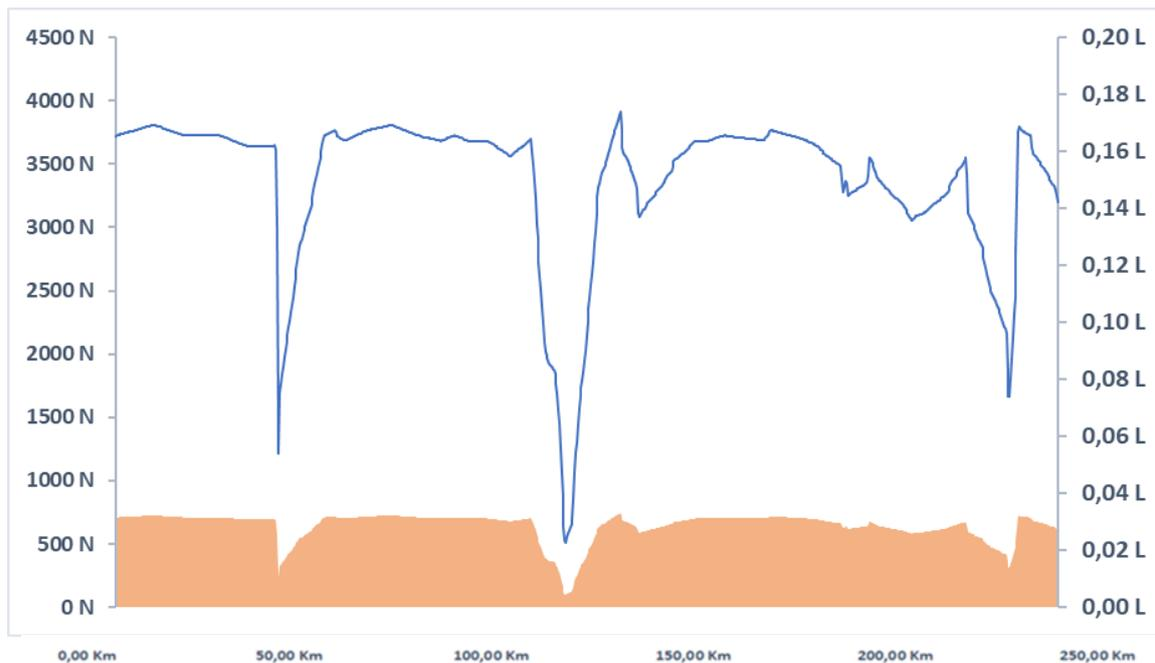
Gráfica 26. Resistencia aerodinámica y consumo en la ruta Zaragoza - Martorell (viaje 1). Curva azul: resistencia aerodinámica. Columnas naranjas: consumo debido a la resistencia aerodinámica. Fuente: propia.
