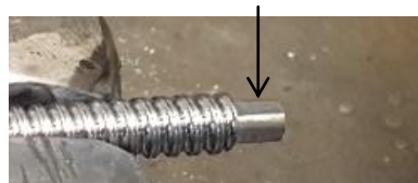
Ilustración 64. Muesca plana sobre el rebaje.
