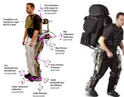
Ilustración 2. BLEEX con los grados de libertad.
