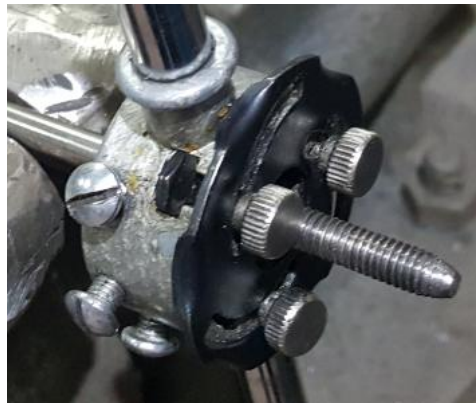
Ilustración 67. Varilla mecanizada con la terraja.
