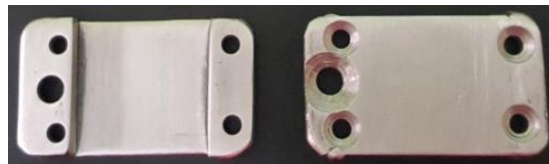
Ilustración 69. Soporte del actuador a la férula.
