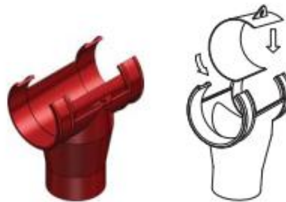
Ilustración 45. Bocas de caída
