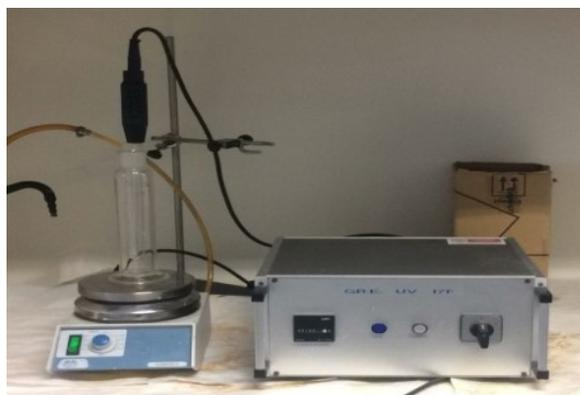
*Figura III.1 .Montaje completo de la instalación con el reactor de pyrex y la fuente de radiación UVC a escala laboratorio.*
