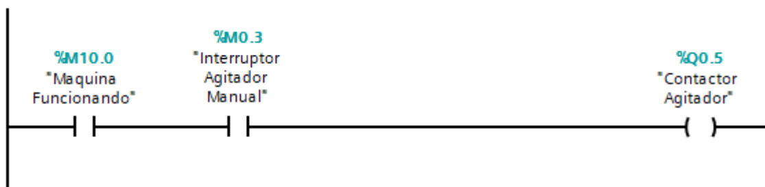
Ilustración 60: Tercer segmento del bloque del modo manual del programa del PLC.
