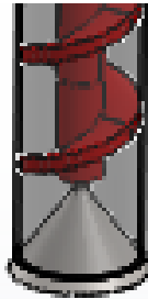
Ilustración 23: Cono de cierre del dosificador.
