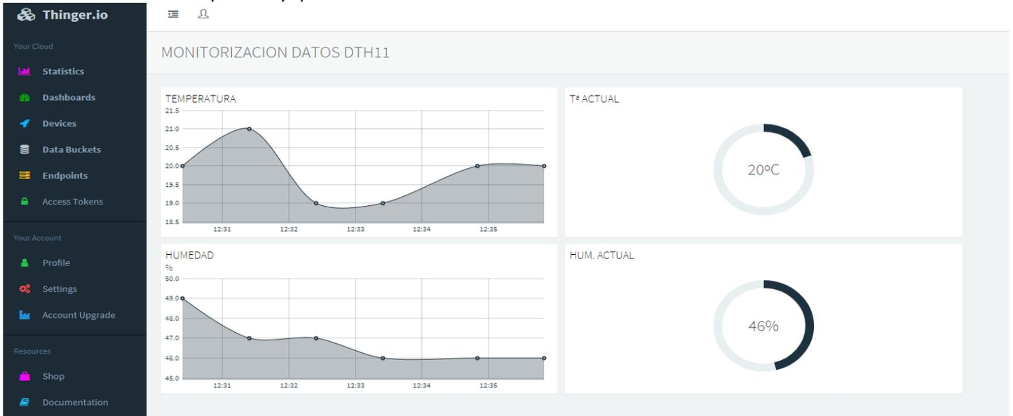
Figura 44: Gráfica con datos de temperatura y humedad tomados por el sensor DHT11
