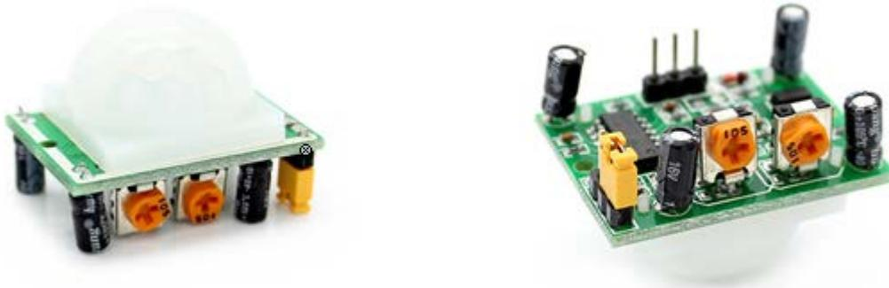
**Figura 6: Detector de presencia PIR HC-SR501**
