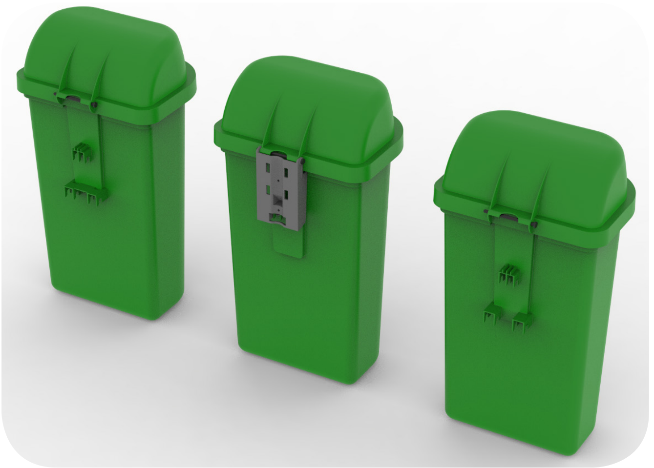
Figura 16.3.3 Vista posterior en tres dimensiones de las tres opciones finales: la de la izquierda, con pieza clipada para soporte antiguo; la del medio, la papelera para soporte nuevo; la de la derecha, los enganches salen del molde para soporte antiguo.
