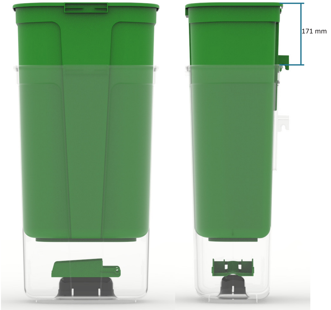
Figura 16.1.5 Vista frontal y lateral del apilado
