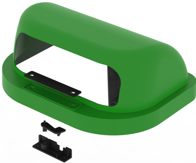
Figura 16.2.3 Explosionado con una vista frontal
