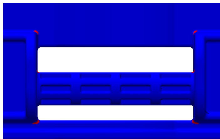
Figura 15.5.7 Coeficiente de seguridad en el soporte
