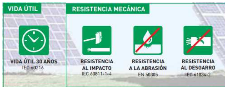
Ilustración 5. Características obligatorias de los cables. Norma IEC.
