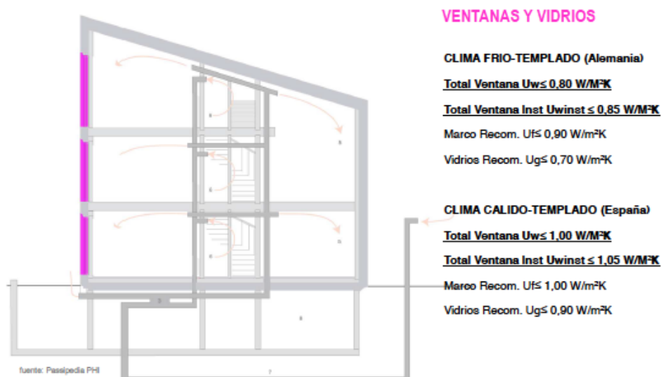
Ilustración 36 Ventanas y vidrios en Passivhaus.
