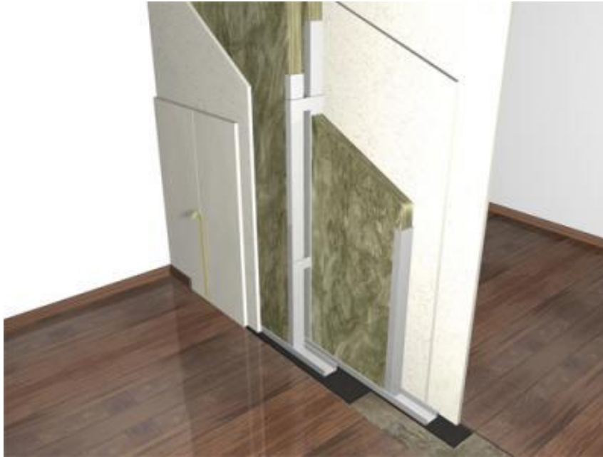
Fotografía 13 Colocación tabiques de cartón yeso.
