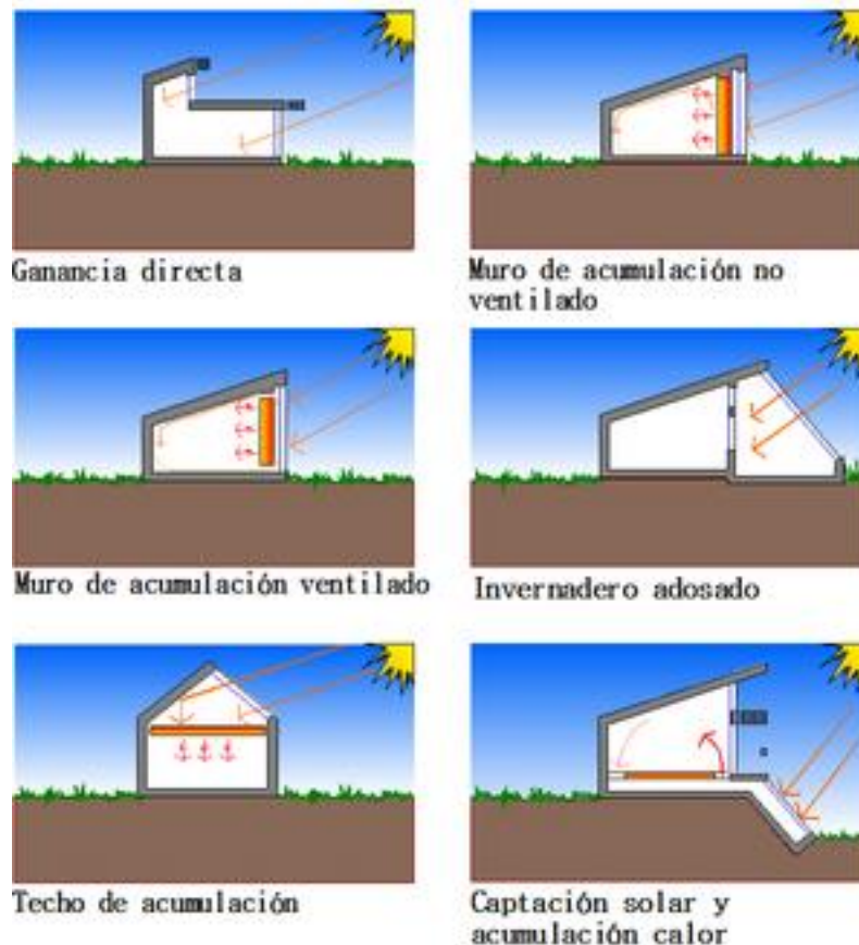
Ilustración 16 Sistemas de captación solar pasiva.
