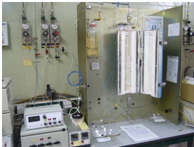
Figura II.2. Imagen de la planta de producción de nanofibras de carbono.
