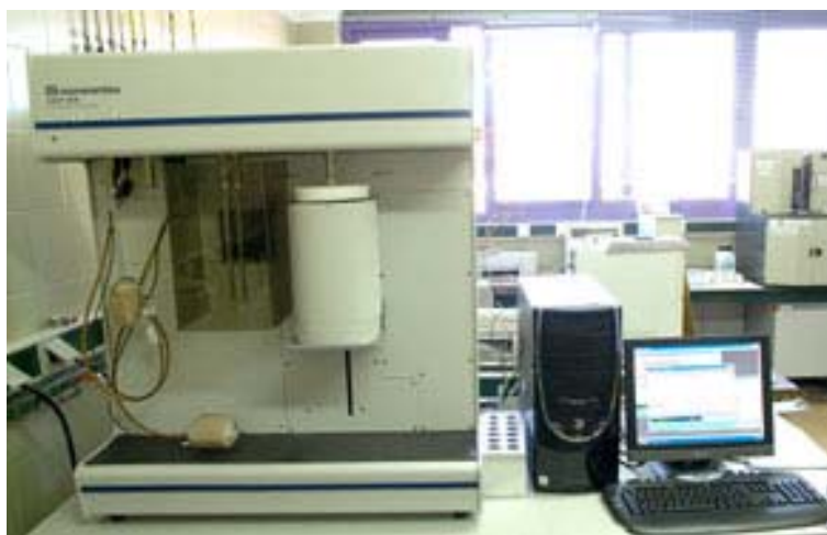
Figura II.17. Equipo de adsorción de gases ASAP 2020.
