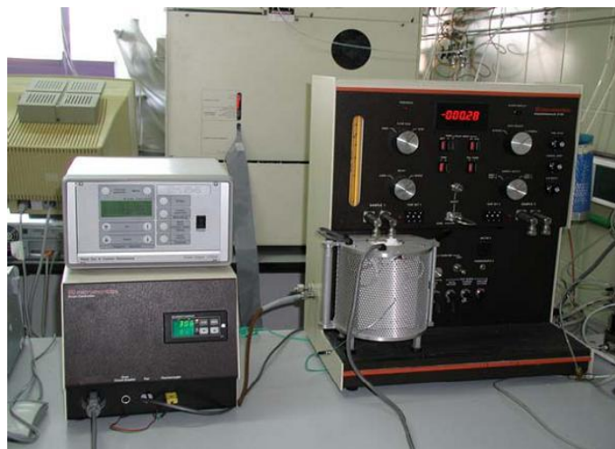
Figura II.16. Equipo TPD Micromeritics Pulse Chemisorb 2700.
