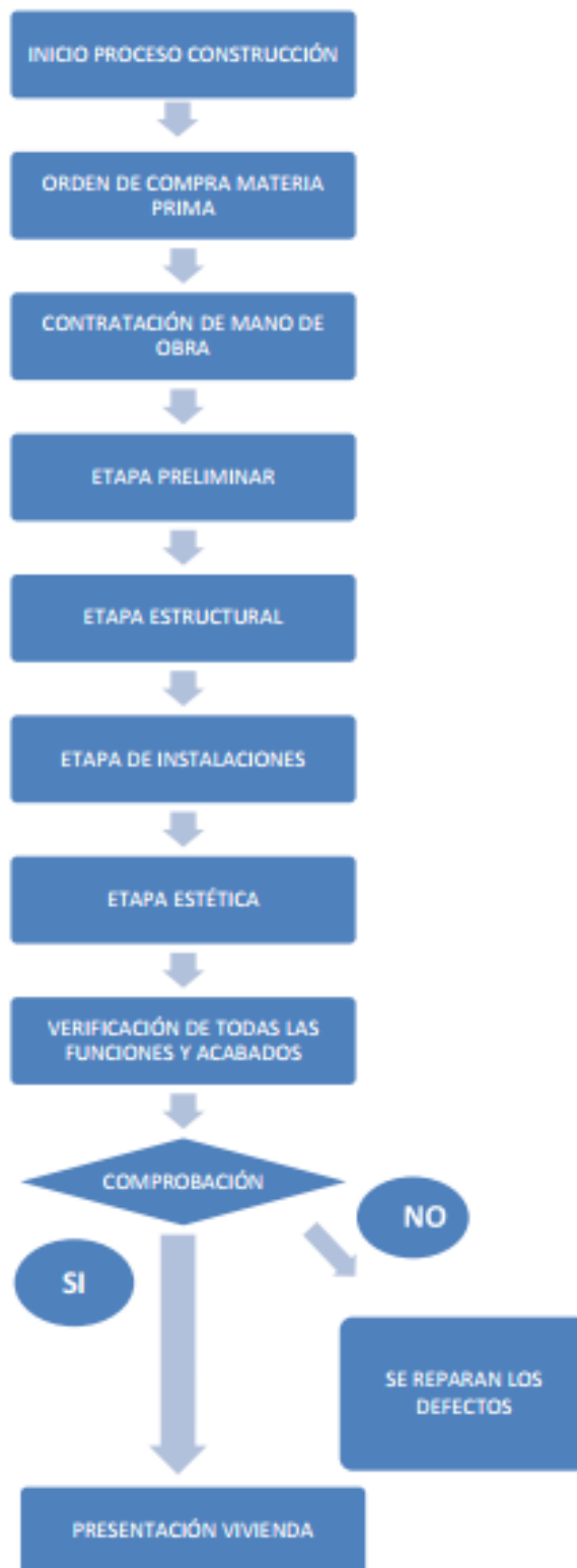
Ilustración 24 Esquema proceso de la construcción. Elaboración propia
