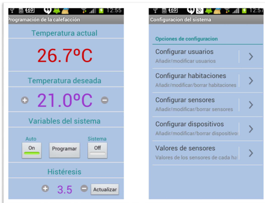
Figura 32 Pantallas de funcionalidad de control calefacción y configuración del sistema
