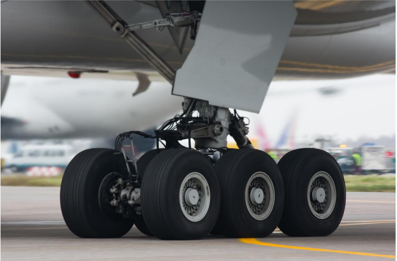
*Fig. 3.19 Tren de aterrizaje principal de un Boeing 777-300 (1)*
