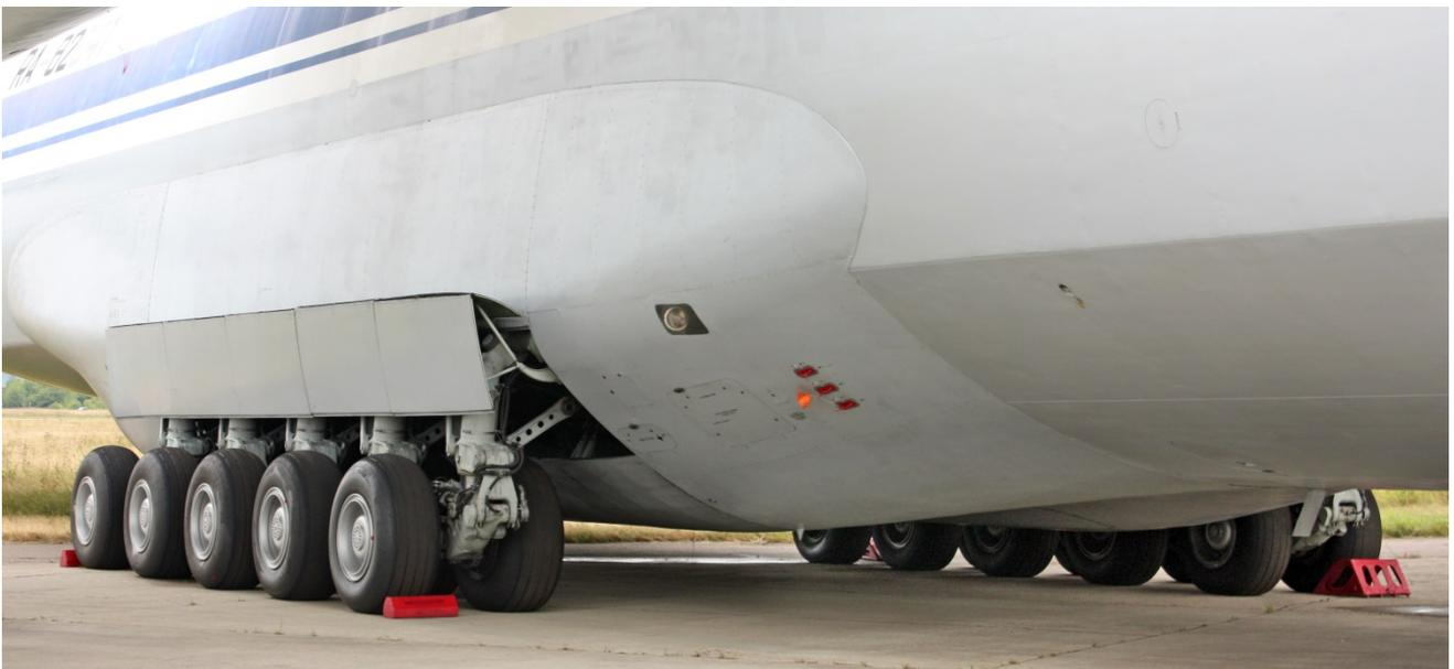
*Fig. 3.20 Tren de aterrizaje principal de un Antonov An-124 (1)*
