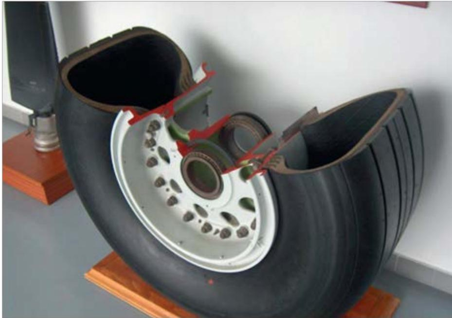
*Fig. 3.1 Sección rueda avión (4)*
