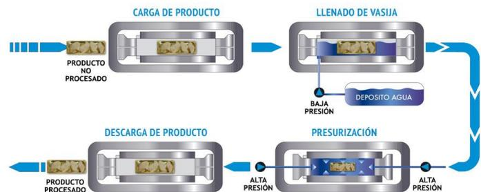
Figura 1.- Esquema de un ciclo de procesado por APH (Hiperbaric, 2012)
