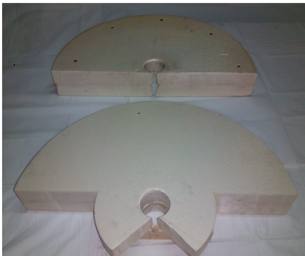
Foto 12 – Desplazadores de poliestireno de distintas formas
