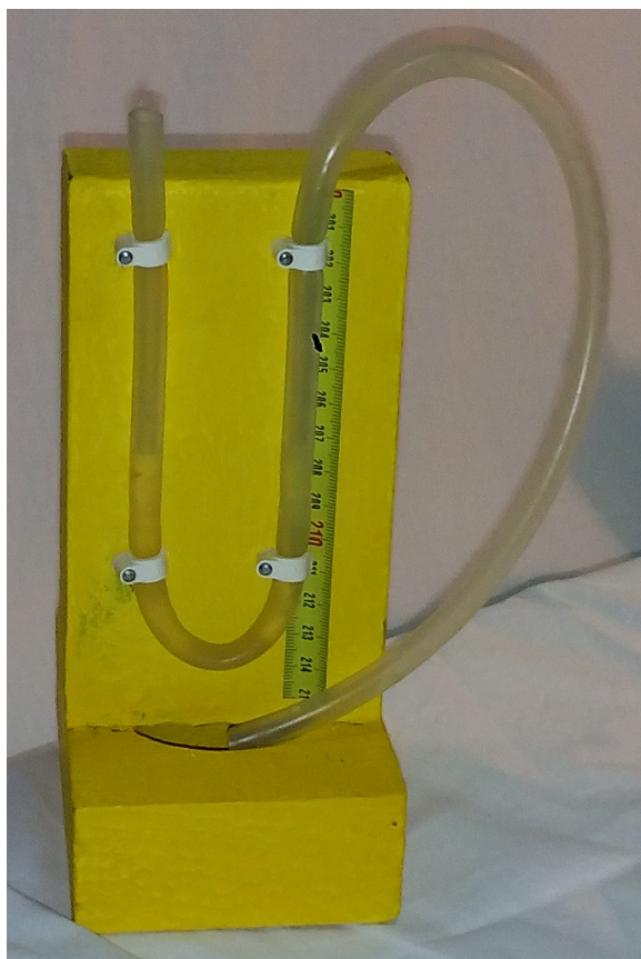
Foto 7 – Manómetro diferencial de columna de agua
