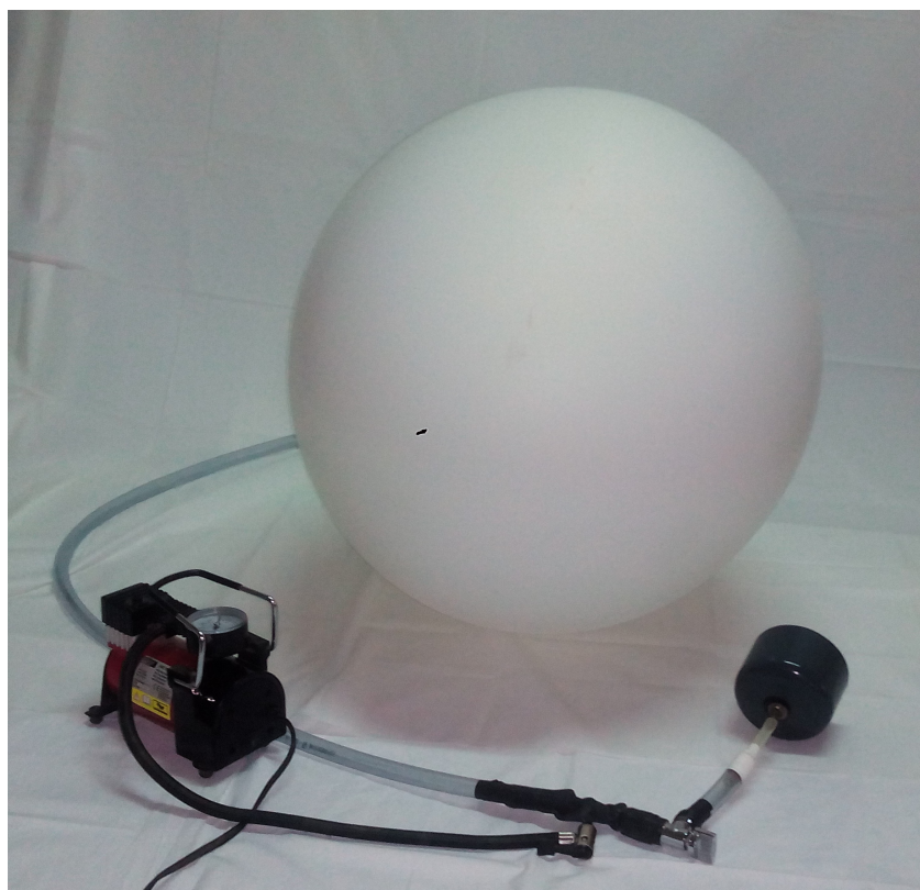
Foto 8 – Generador de aire de baja presión
