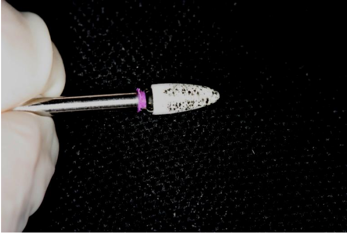
Fig. 20: Fresa Arkansas impregnada de partículas metálicas
