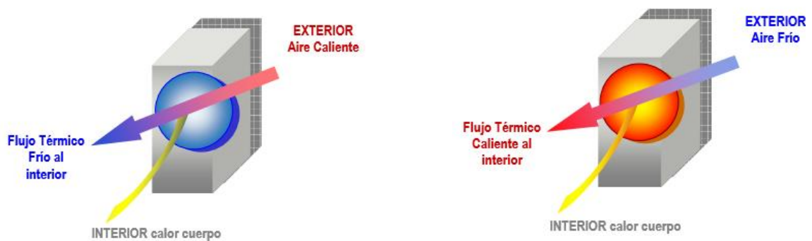
Figura 5. 2 T_{\text{ambiente}} < T_{\text{fusión PCM}} [15]
