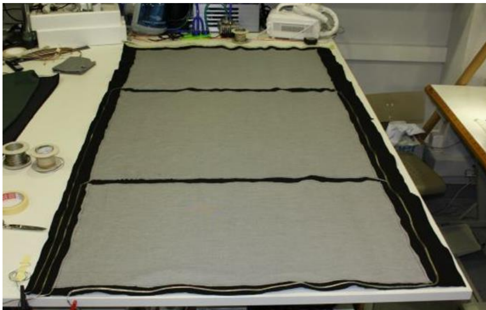
Figura 5. 30 Circuito eléctrico completo sobre la base textil.
