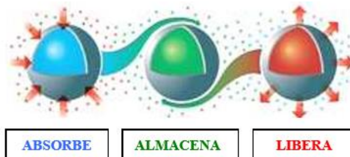
Figura 5. 3 Absorción y liberación de calor en una microcápsula PCM [15]
