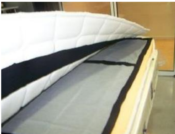
Figura 5.33 Colocación del textil electrotérmico
