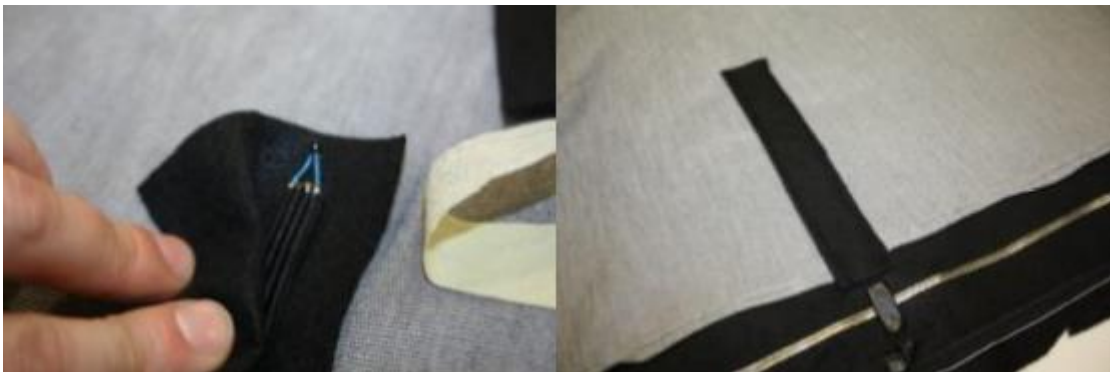
Figura 5. 32 Izq Sensor conectado a cable textil; Der Acabado se sensores NTC
