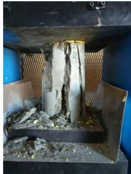
HORMIGÓN AUTOCOMPACTANTE DE CONTROL
