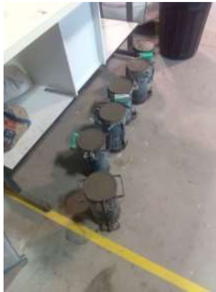
Ilustración 12 Llenado de probetas
