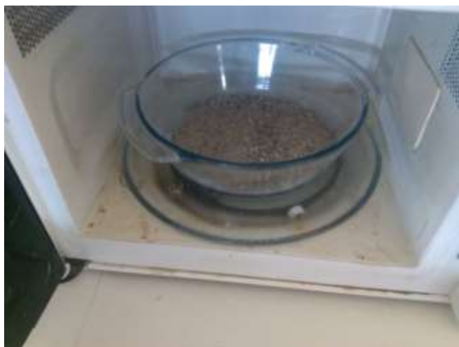
Ilustración 2 Desecado de la muestra de arena
