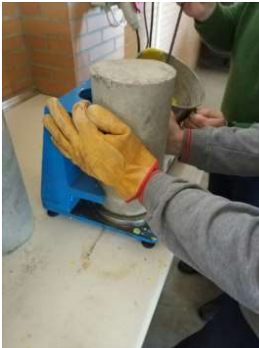
Ilustración 15 Colocación de probetas para refrentado
