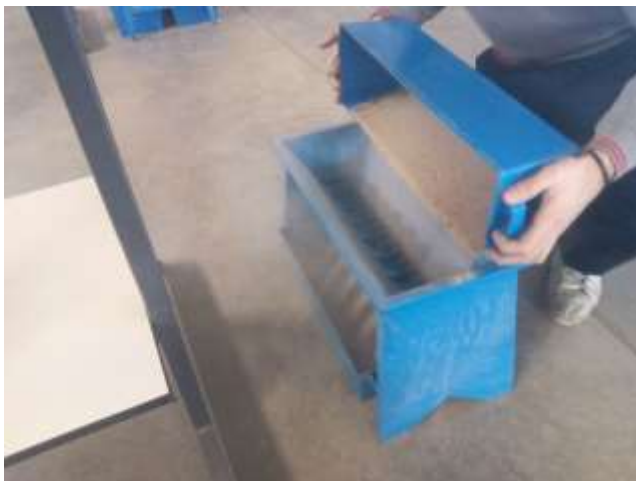
Ilustración 1 Cuarteado de la muestra
