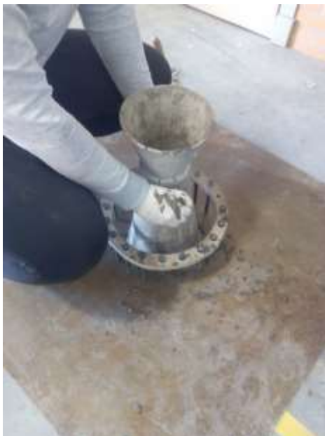
Ilustración 9 Llenado de cono de Abrams
