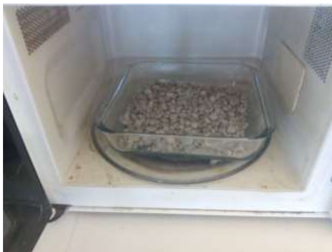
Ilustración 4 Dsecado de la muestra de grava
