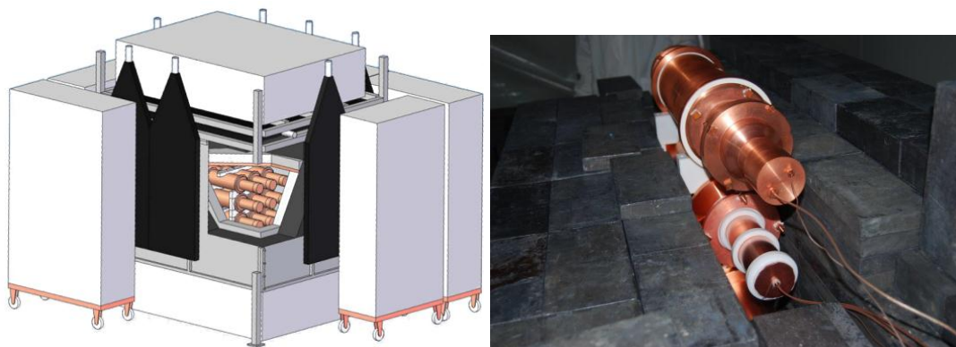
Figura 1.2. Izquierda: Vista esquemática del montaje ANAIS. Los 9 cristales centelleadores de alta radiopureza de NaI(Tl), alojados en una caja de (de dentro a afuera): 10 cm de plomo antiguo, 20 cm de plomo de baja actividad, 40 cm de moderador de
