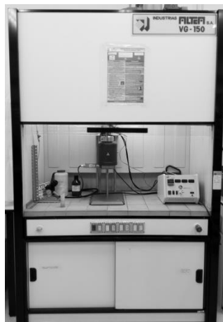
Figura I 7. Micro reactor Parr dentro de la campana de extracción de gases
