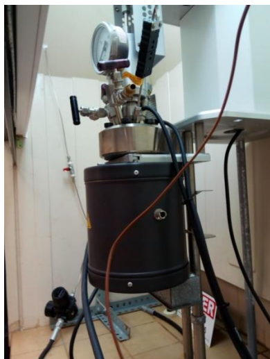
Figura I 1. Micro reactor Parr montado dentro del horno
