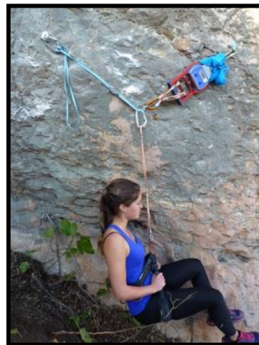
Figura 38: Una de las mediciones colocando el dinamómetro en el seguro derecho y con un ángulo en el punto central de 120°.
