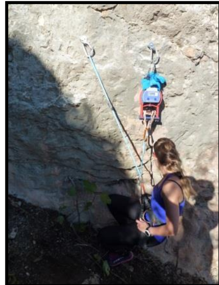
Figura 31: Una de las mediciones colocando el dinamómetro en el seguro derecho y con un ángulo en el punto central de 30°.
