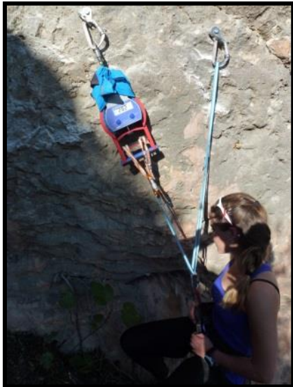
Figura 32: Uno de las mediciones colocando el dinamómetro en el seguro izquierdo y con un ángulo en el punto central de 30°.
