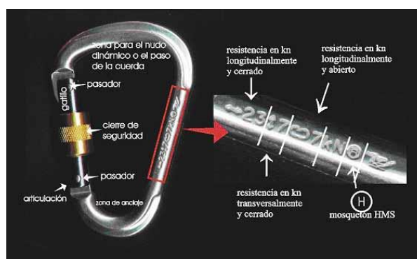
Figura 15: Datos resistencia mosquetón (Lewis & Cauthorn, 2002).
