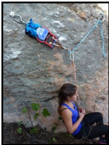
Figura 39: Una de las mediciones colocando el dinamómetro en el seguro izquierdo y con un ángulo en el punto central de 120°.
