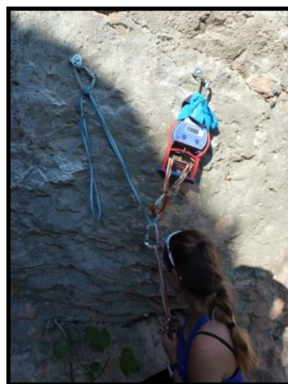
Figura 35: Una de las mediciones colocando el dinamómetro en el seguro derecho y con un ángulo en el punto central de 60°.
