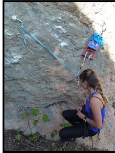
Figura 36: Una de las mediciones colocando el dinamómetro en el seguro derecho y con un ángulo en el punto central de 90°.
