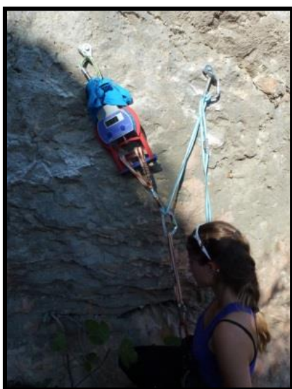
Figura 34: Una de las mediciones colocando el dinamómetro en el seguro derecho y con un ángulo en el punto central de 60°.
