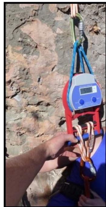
Figura 30: Momento de una de las tres mediciones del peso del sujeto colgándolo directamente desde el punto central de la reunión.
