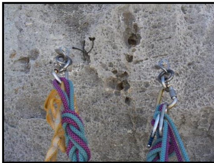
Figura 16: Ejemplo de reunión en línea horizontal sin triangular.
