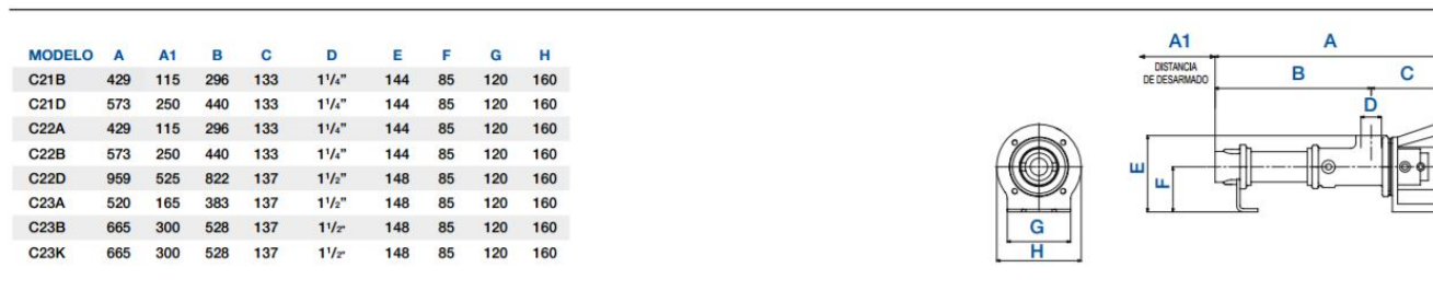
Ilustración 18: Dimensiones de la bomba Compact
