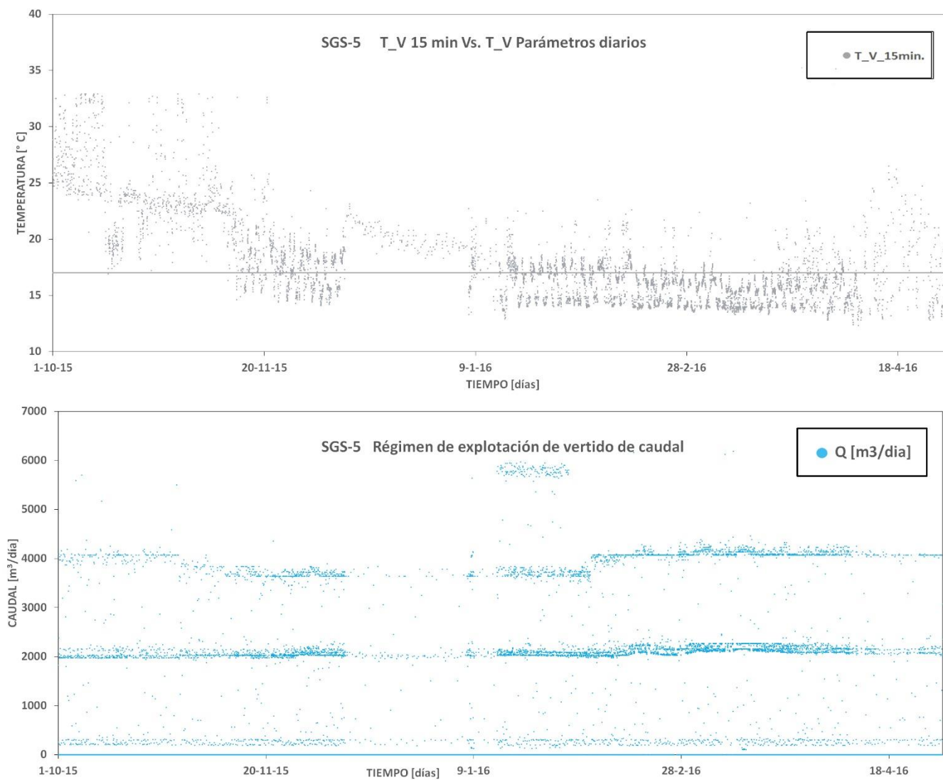
Anexo 1E. Gráficas del régimen de funcionamiento real de la instalación SGS-5 a partir de la temperatura y el caudal de vertido.
