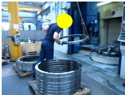
**2.1.2 Colocación de la pieza en el plato, deslingado y ajuste y apriete de la misma a la máquina.**
