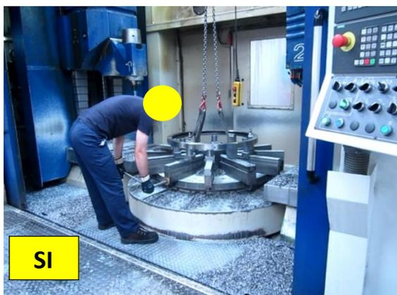
Fig. 14: Posición correcta para la ejecución de la tarea
