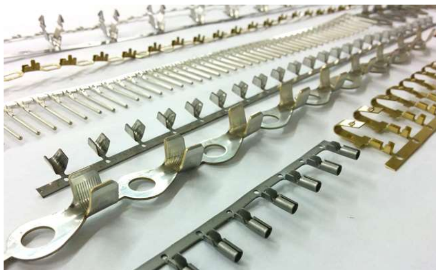
Ilustración 1: Arriba: Prensa mecánica de doble montane. Abajo: Bandas de piezas hechas por estampación.
