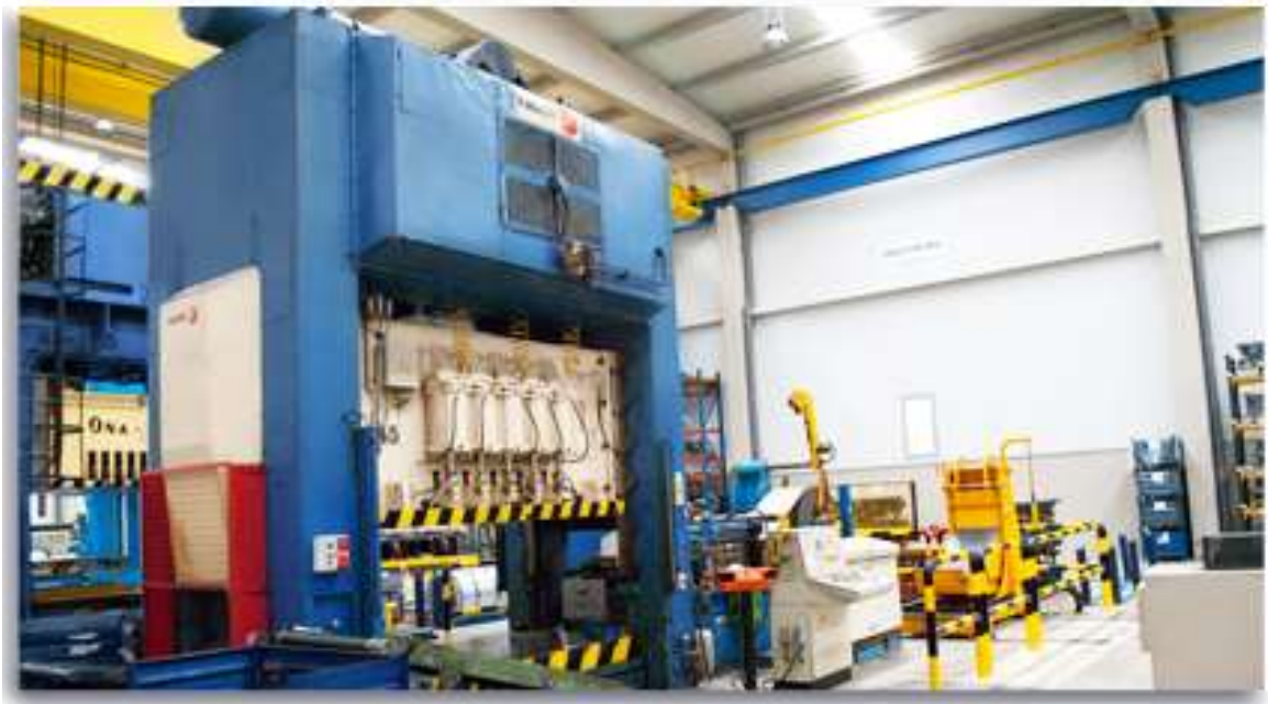
Ilustración 1: Arriba: Prensa mecánica de doble montane. Abajo: Bandas de piezas hechas por estampación.
