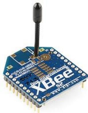
*Ilustración 70. Módulo ZigBee.*
