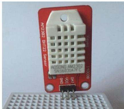
*Ilustración 106. Módulo DHT22.*
