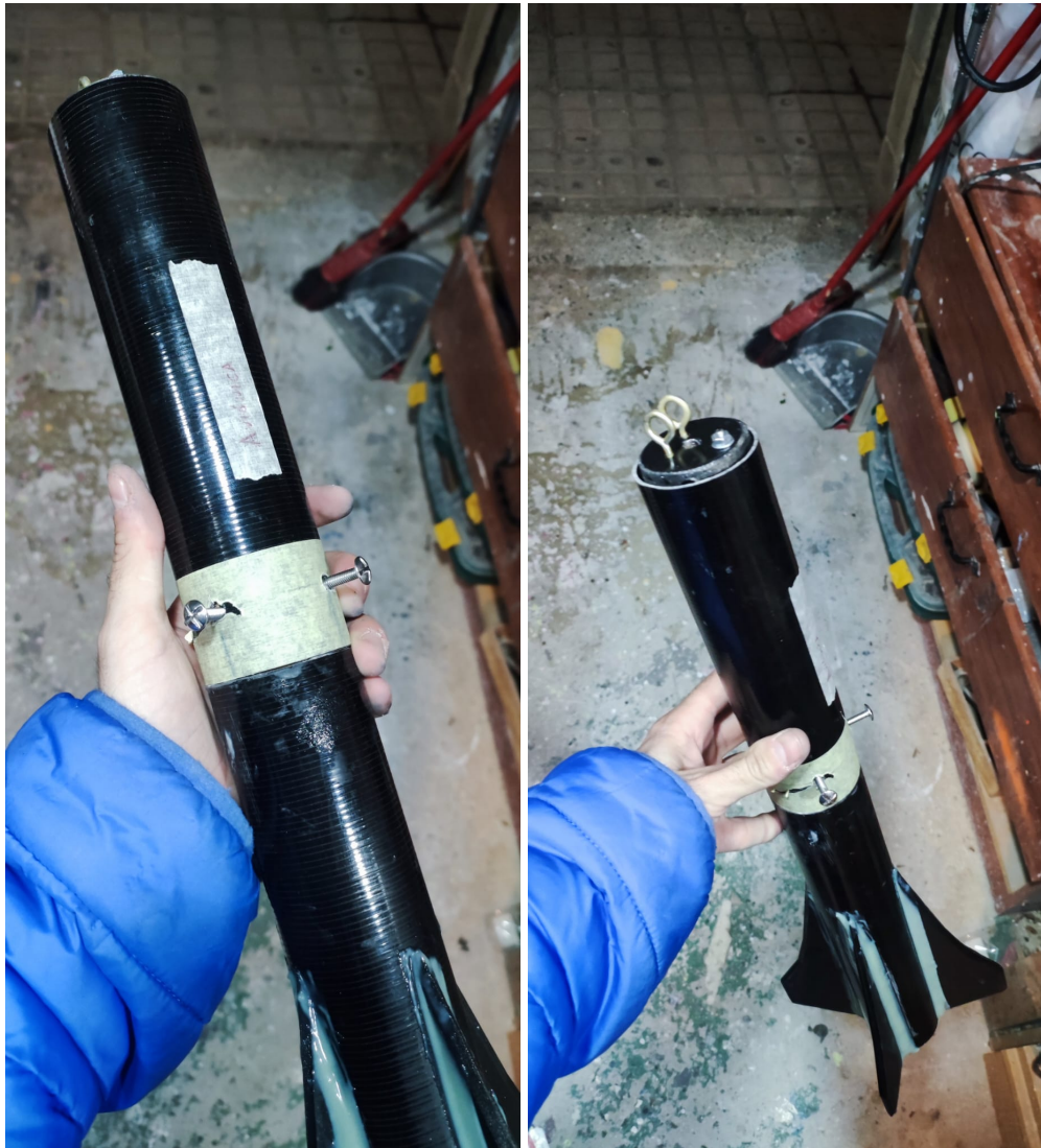
Figura 73.0: Resultado de los tornillos ensamblando la cápsula de electrónica con los acopladores y el fuselaje.
