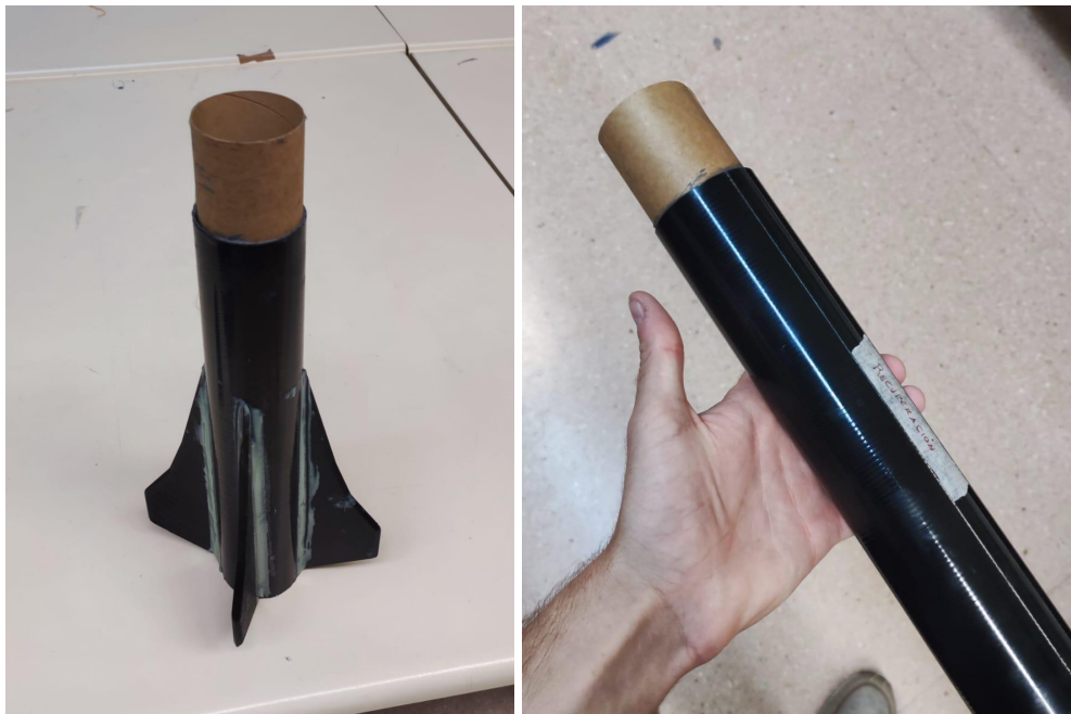
Figura 71.0: Ensamblaje de los acopladores mediante epoxi.
