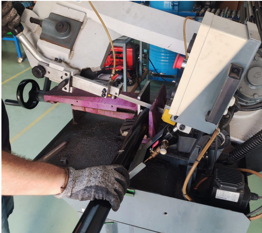
Figura 29.0: Corte del tubo de fibra de vidrio en secciones.
