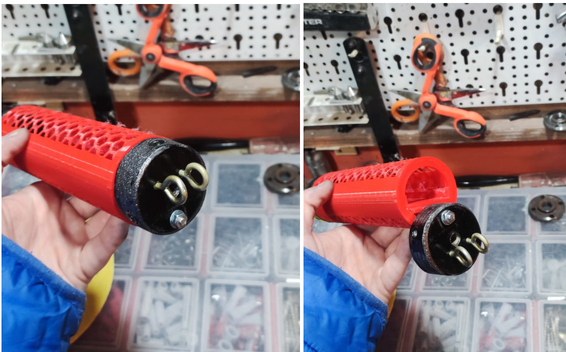
Figura 43.0: Resultado final del sistema de encapsulamiento completo, posterior lijado y pintado de las tapas.
