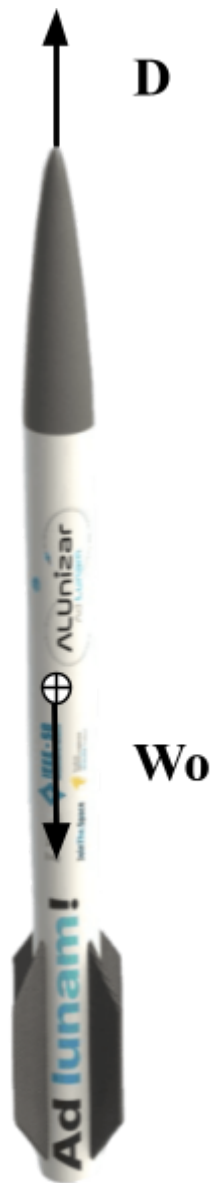
Figura 14.0: Diagrama de fuerzas del cohete durante el descenso.
