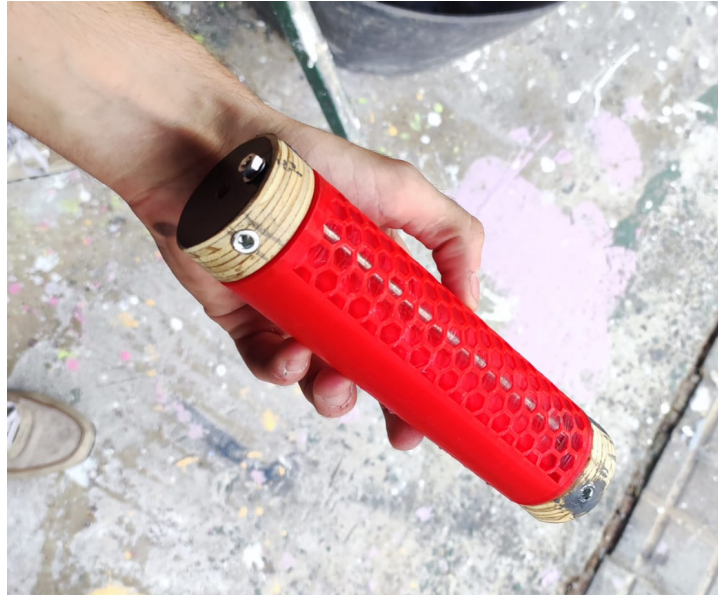
Figura 42.0: Resultado final del sistema de encapsulamiento completo, previo lijado y pintado de las tapas.
