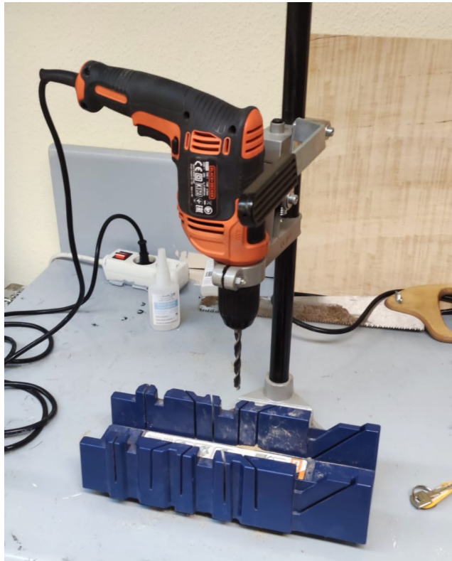
Figura 40.0: Perforación de los agujeros para la varilla en las tapas.
