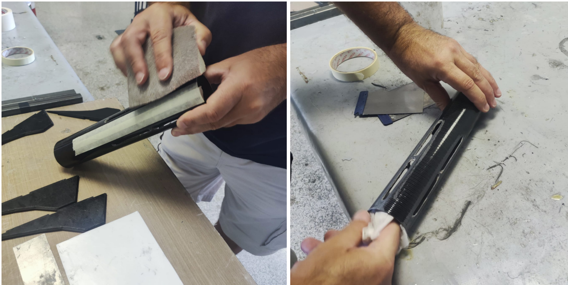
Figura 65.0: Lijado y limpieza del tubo de fibra de vidrio.
