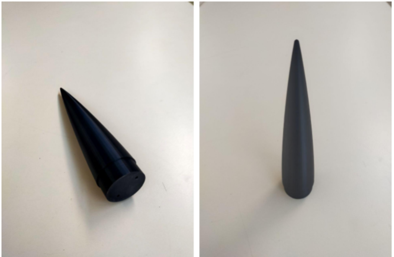
Figura 55.0: Resultados de la ojiva impresa en PLA.
