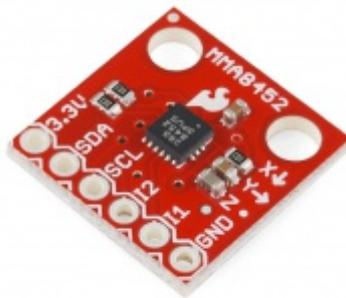
**Figura 45** Acelerómetro utilizado para detectar la posición del paciente
