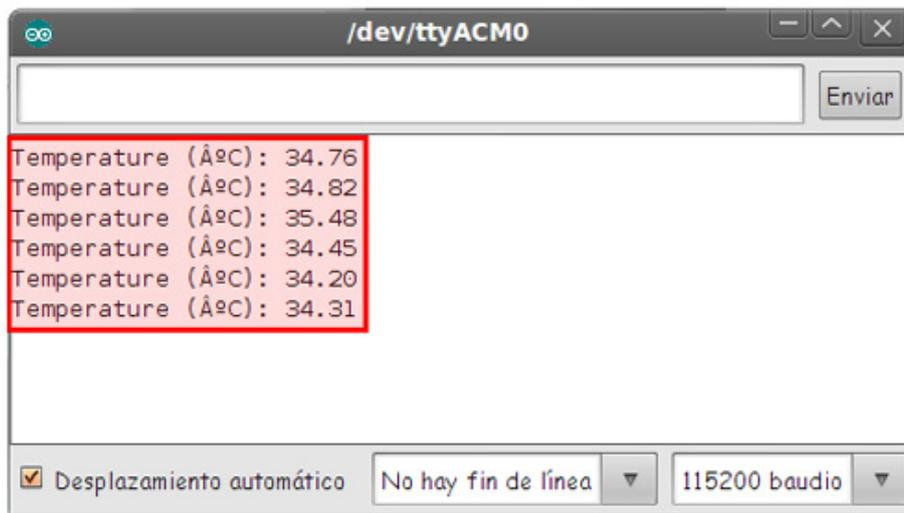
**Figura 82** Visualización de la medida de temperatura por medio del monitor serie de Arduino
