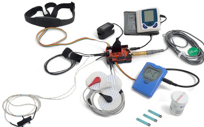
**Figura 74** Conexión final de todos los sensores sobre e-Health Versión 1
