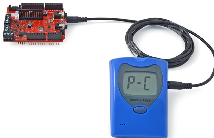
**Figura 56** Conexión del sensor de glucosa
