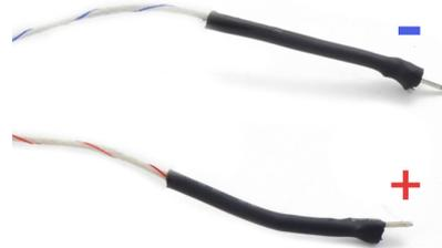
**Figura 31** Polaridad del sensor de respiración
