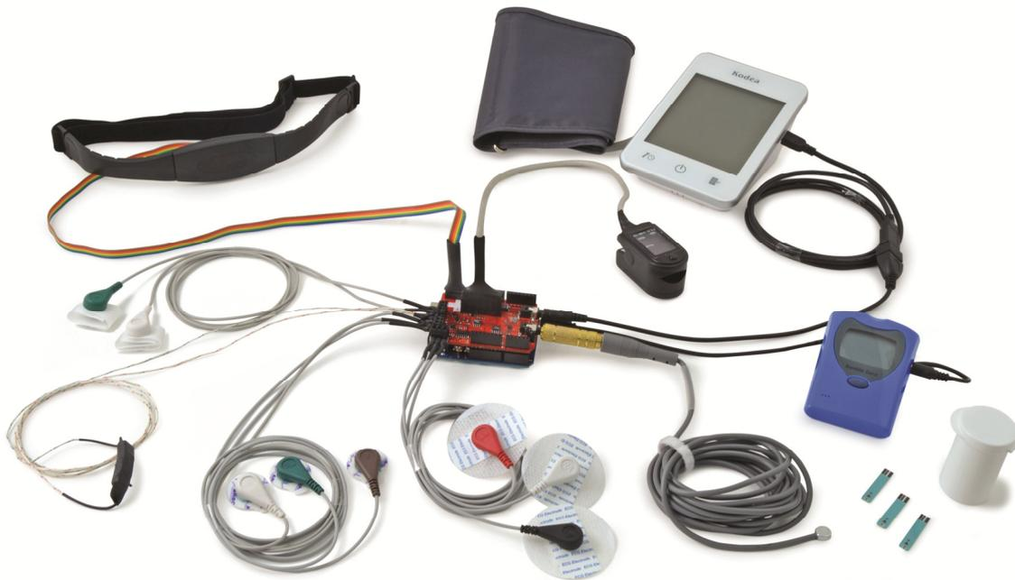
**Figura 75** Conexión final de todos los sensores sobre e-Health Versión 2
