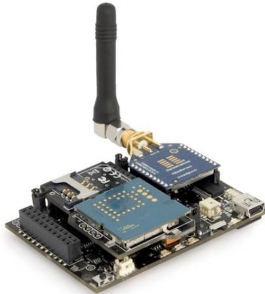
**Figura 14** Imagen de Wasmote con módulos XBee y GPRS incluidos
