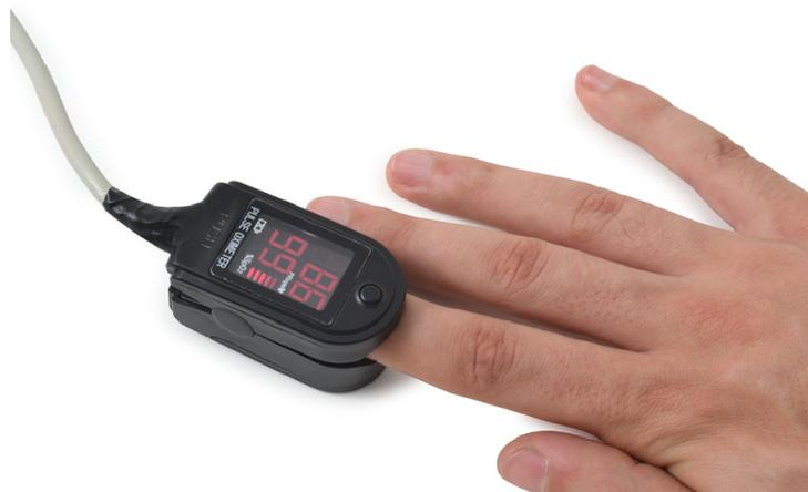
**Figura 25** Medición en proceso del sensor SpO2
