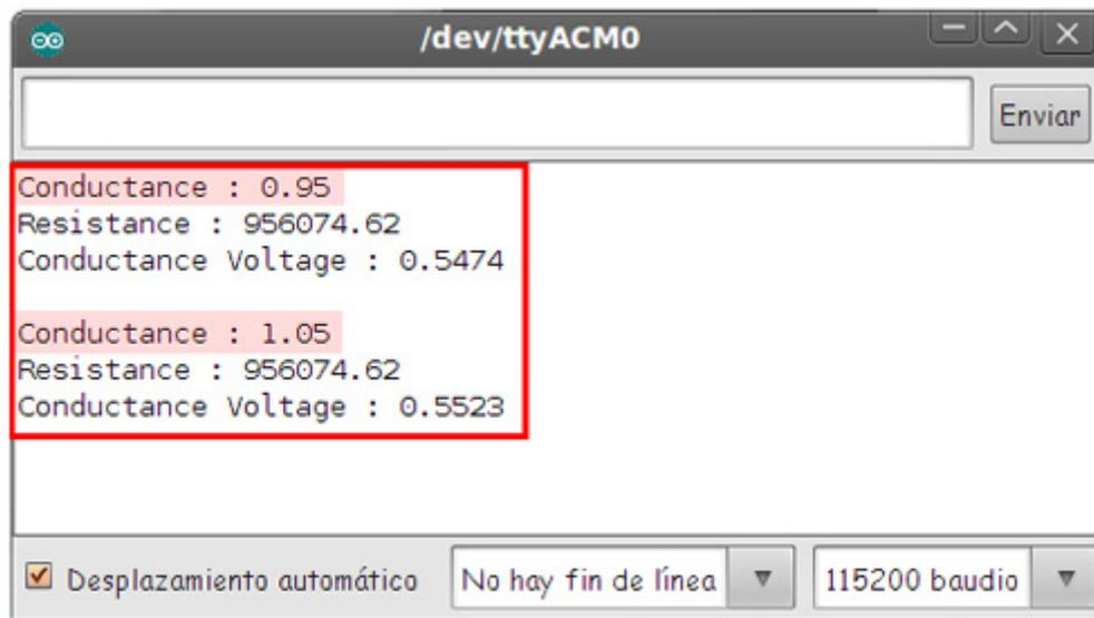
**Figura 86** Visualización de la medida de conductividad por medio del monitor serie de Arduino
