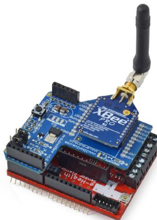
**Figura 105** Ejemplo combinado de e-Health con tecnología XBee
