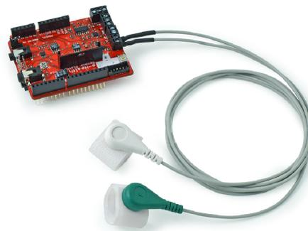
**Figura 50** Conexión de los sensores conductividad de piel
