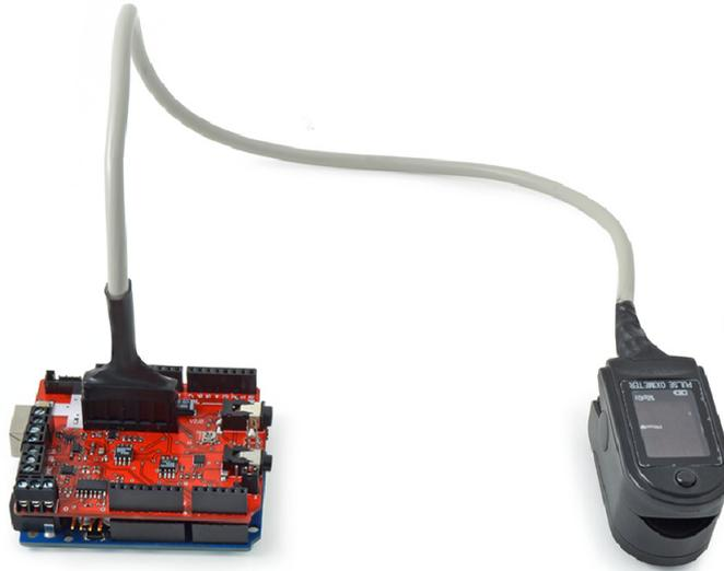
**Figura 24** Sensor SpO2 conectado sobre la placa e-Health
