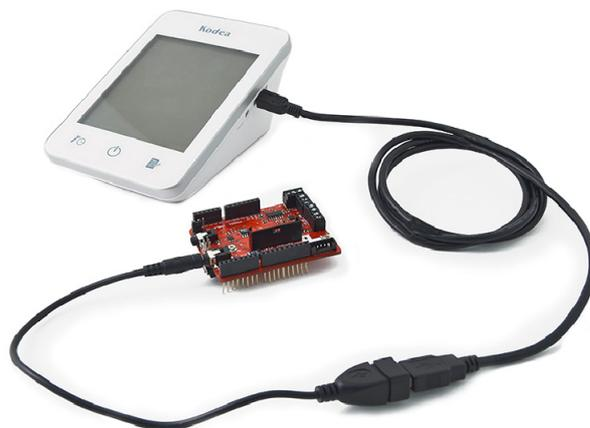
**Figura 42** Conexión del sensor de tensión sanguínea Versión 2
