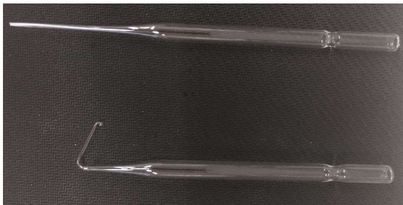
Figura 6: Pipeta Pasteur original y con forma de asa para realizar la siembra.
