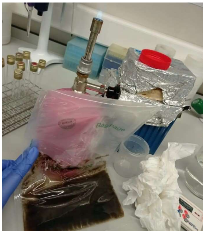
Figura 2: Proceso de extracción de una muestra de fango deshidratada.
