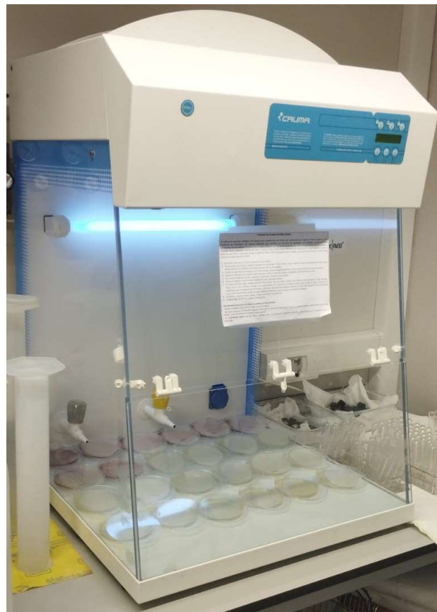
Figura 4: Cabina de flujo laminar en funcionamiento.
