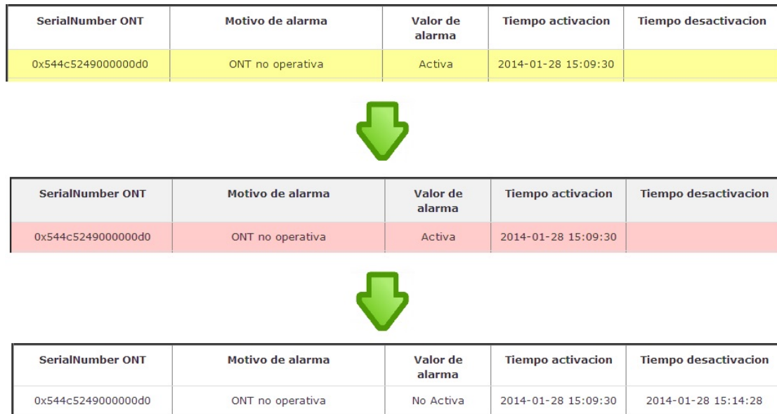
Figura 4.13: Activación de alarma por desconexión de ONT
