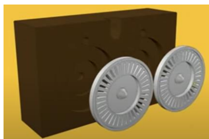
Ilustración 6: Plano de los moldes y machos de arena verde
