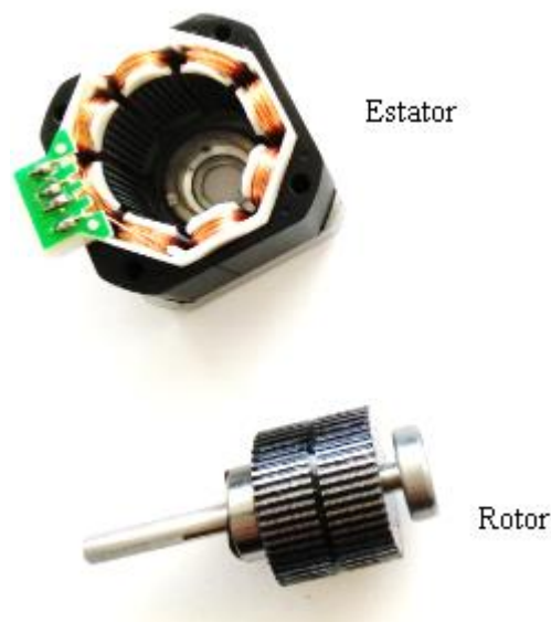
Figura 5. Interior motor bipolar paso a paso. [Fuente propia].
