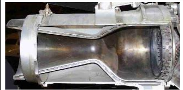
Figura 6 - Sección del motor cohete "Spectre", fabricado por la empresa inglesa "de Havilland" [5].
