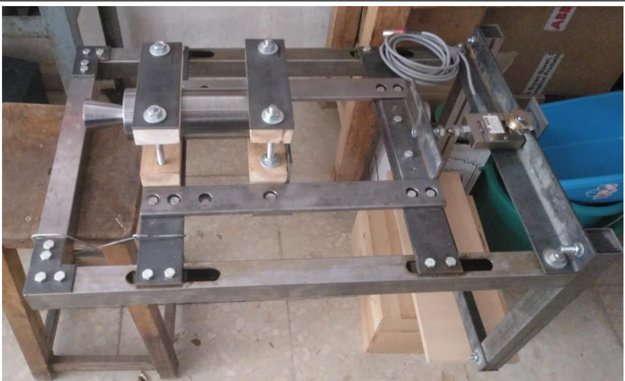
Figura 25 - Banco de pruebas (a la derecha, la célula de carga y a la izquierda, el motor).
