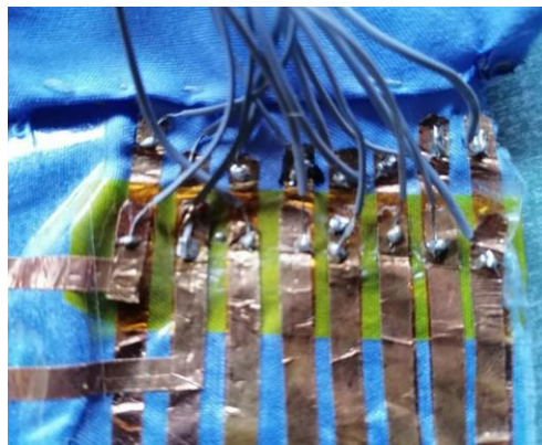
Figura 24- Imagen de como se han soldado los cables
