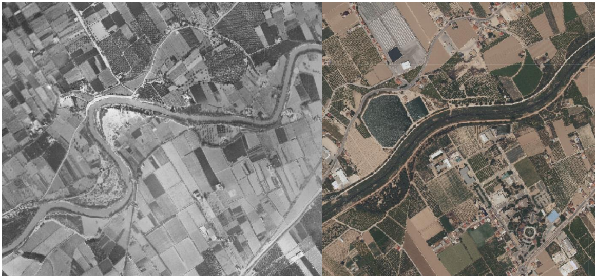
Figura 5.67. Eliminación de meandros, instalación de infraestructuras de explotación, simplificación de cultivos, eliminación de vegetación de ribera, ocupación industrial de la llanura y emplazamiento de campus universitario (Universidad Miguel Hernández). Fuente: Visor CHS.
