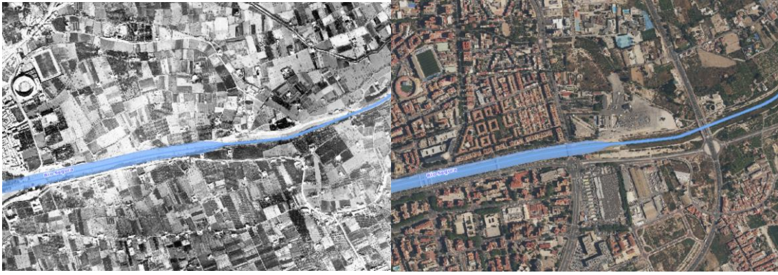
Figura 5.60. Ampliación de la ciudad de Murcia, incremento de zonas industriales y reducción de la superficie y mosaico de cultivo e instalación de infraestructuras lineales y obstáculos transversales. Fuente: Visor CHS.
