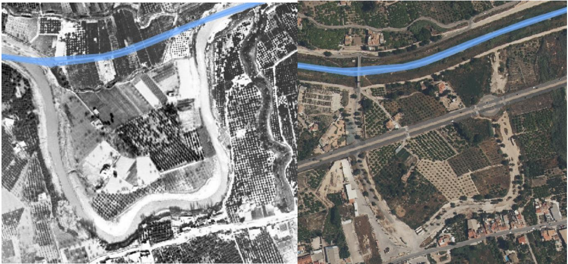
Figura 5.61. Eliminación de meandro, instalación de infraestructura lineal, construcción de viviendas, cambios en el mosaico y superficie de cultivos y eliminación de vegetación de ribera. Fuente: Visor CHS.
