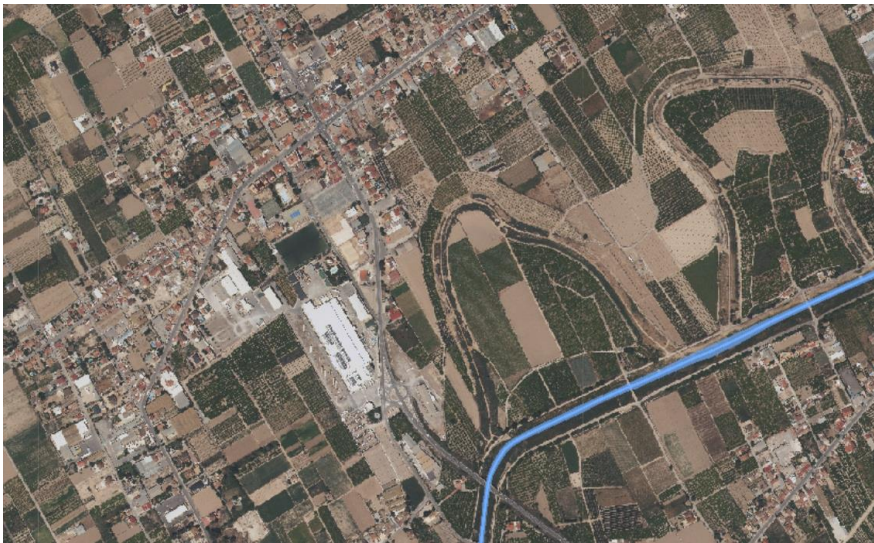
Figura 5.64. Eliminación de meandros, aumento del proceso urbanístico (El Raal) e industrial y simplificación de cultivos. Fuente: Visor CHS.
