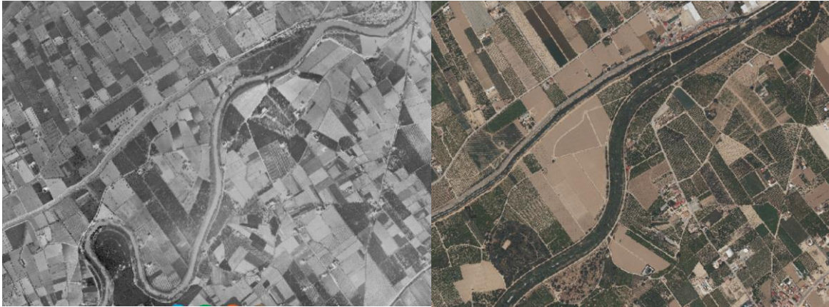
Figura 5.66. Eliminación de meandros, reducción de sotos, simplificación de cultivos y aumento de la edificación. Fuente: Visor CHS.
