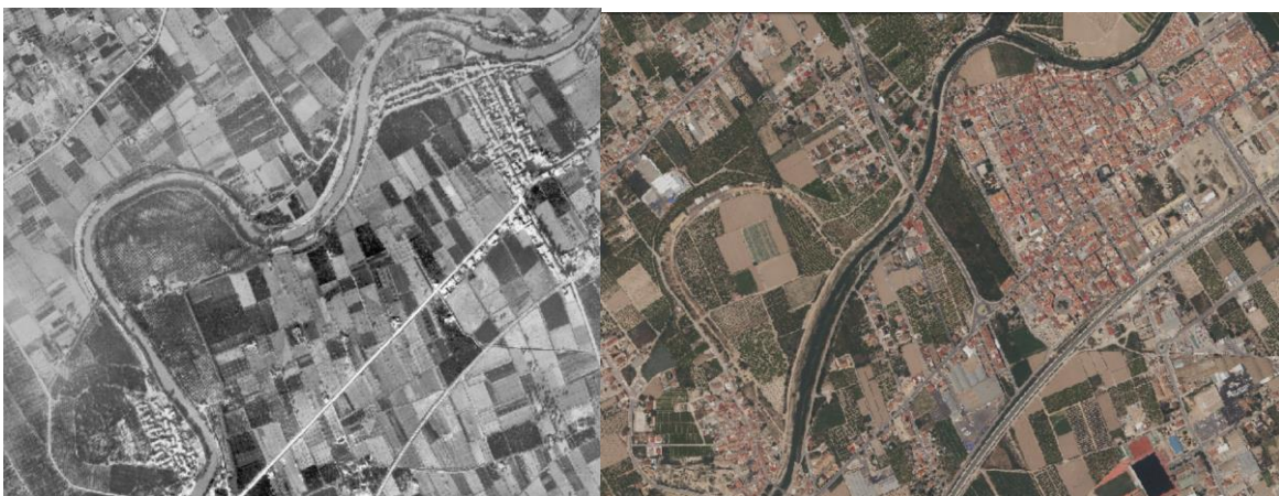
Figura 5.65. Eliminación de meandro, incremento de edificaciones del tipo residencial (El Raal y Beniel), aumento de suelo industrial, construcción de infraestructuras lineales y de obstáculos transversales y eliminación de vegetación de ribera. Fuente: Visor CHS.
