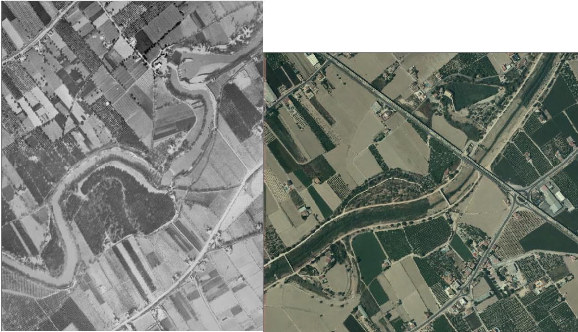
Figura 5.68. Eliminación de meandros y sotos, eliminación de vegetación de ribera, simplificación de cultivos, instalación de obstáculos transversales, presencia de zonas industriales y residenciales y eliminación de obras de represamiento. Fuente: Visor CHS.
