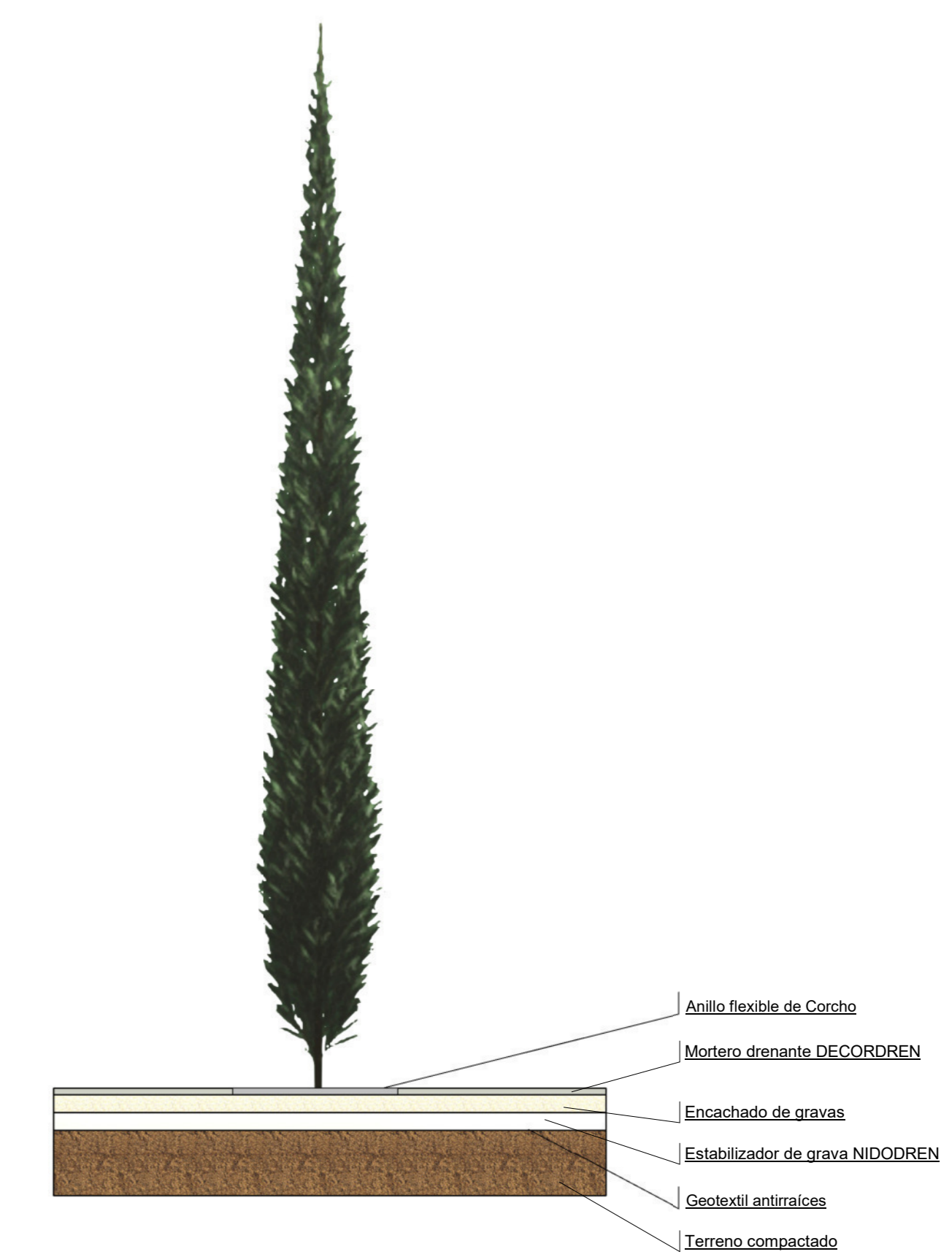
Detalle sección constructiva alcorques.
