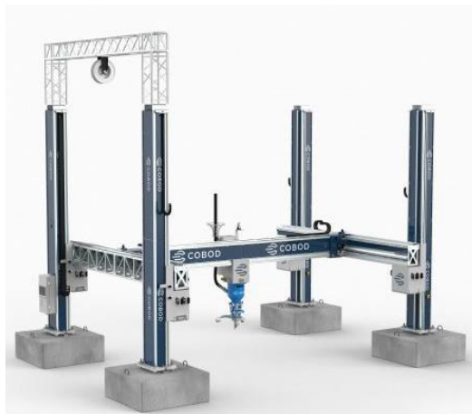
Figura 1.5.7. Estructura de BOD2 7
