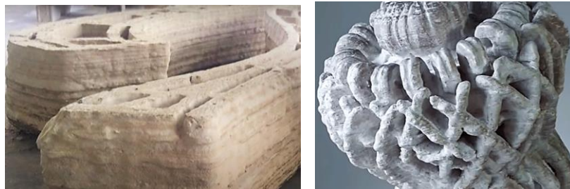
Figura 2.10. Prototipos impresos con D-Shape. 22
