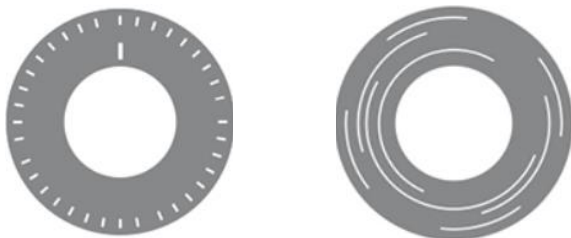
Figura 2.19. Encoder absoluto e incremental 29
