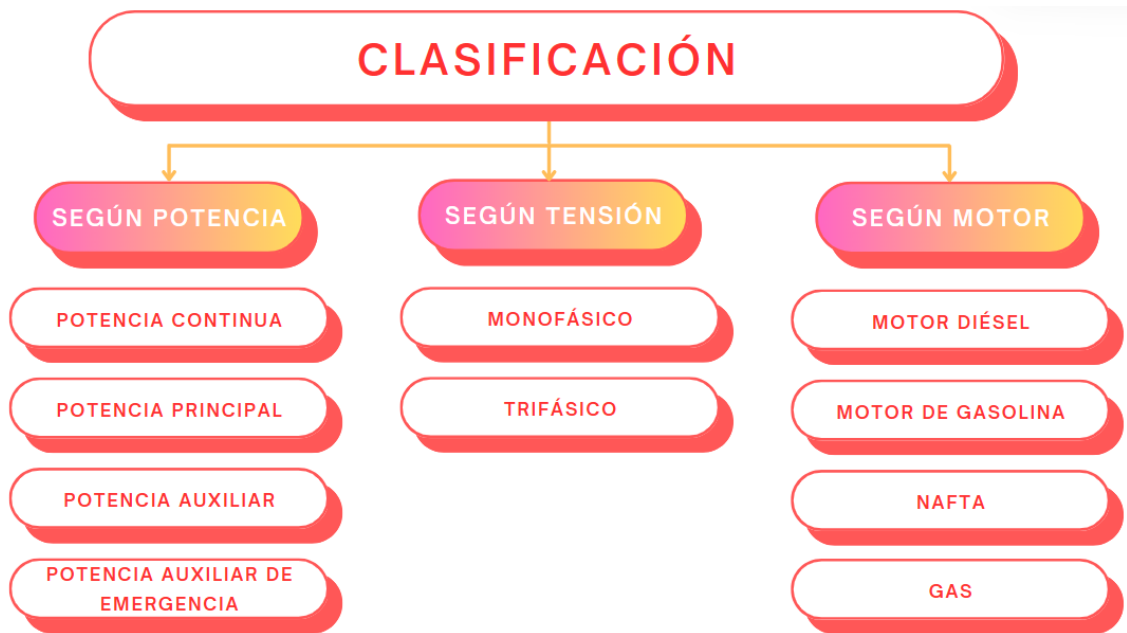
Figura 2.16. Clasificación de grupos electrógenos.
