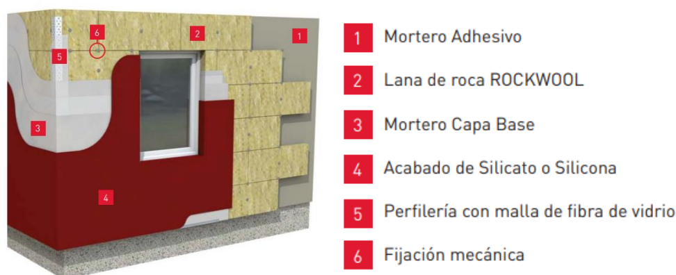
Figura 2. Sistema de Aislamiento Térmico por el Exterior RED ART (fuente ROCKWOOL)
