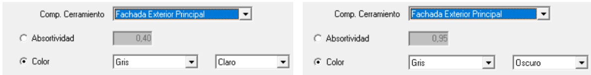
Fig. 11 Color fachadas después de rehabilitación energética.
