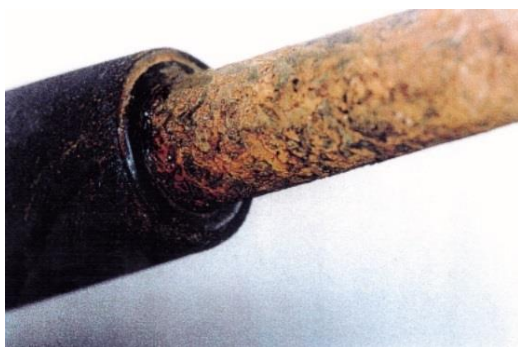
Imagen 17 - Bastón Monadnock tras 24 horas de exposición a Niebla salina. Visión tramo empuñadura. Fuente: Propia.
