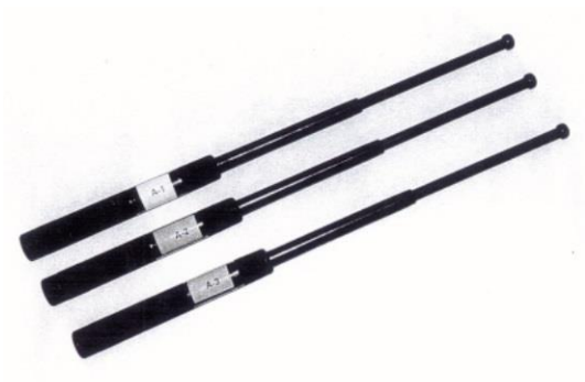
Imagen 12 – Bastón ASP tras 24 horas de exposición a Niebla salina. Visión completa. Fuente: Propia.
