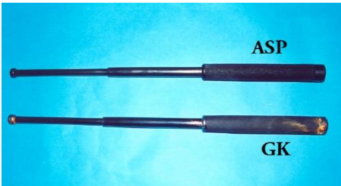
Imagen 16- Comparativa bastón ASP vs GK tras 44 horas de exposición a niebla salina. Visión completa. Fuente: Propia.
