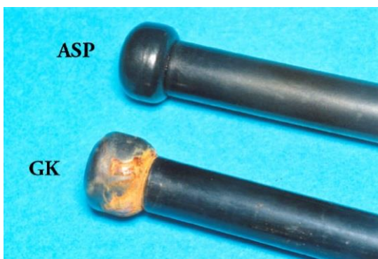
Imagen 14- Comparativa bastón ASP vs GK tras 44 horas de exposición a niebla salina. Visión punta. Fuente: Propia.
