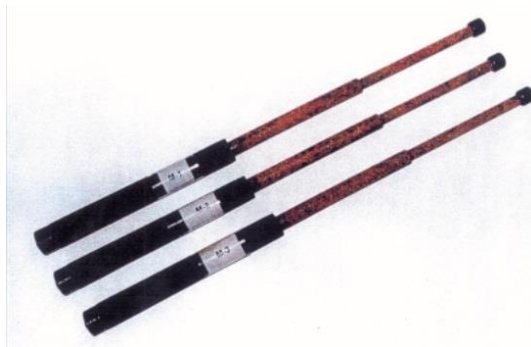
Imagen 13- Bastón Monadnock tras 24 horas de exposición a Niebla salina. Visión completa. Fuente: Propia.
