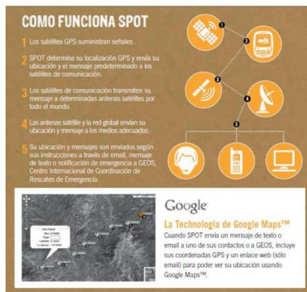
Ilustración 0-1. Funcionamiento del SPOT GEN3. Fuente: Findmespot.com.
