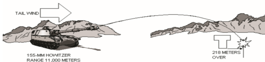
Ilustración 2. Efecto del viento de cola en el proyectil. Fuente (US Army, 2007)
