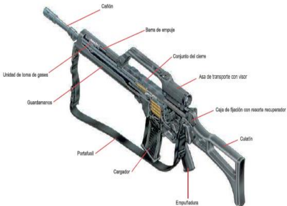
Figura 3: Vista y partes del fusil HK G36E
